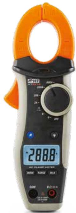
La pinza amperometrica HT9012 è progettata per la misura di **corrente AC fino a 600A** e **Tensione AC/DC fino a 1000V** per il raggiungimento della **CAT IV 600V** e **CAT III 1000V** in accordo alla norma **IEC/EN61010-1**. La pinza è dotata di un ampio **display retroilluminato a 6000 punti di misura** e di una funzione di autospegnimento per preservare la durata della batteria.
