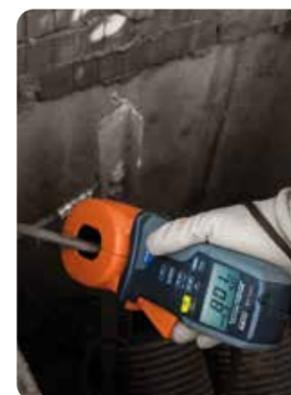
Misura della resistenza di Terra con Pinza T2100.
