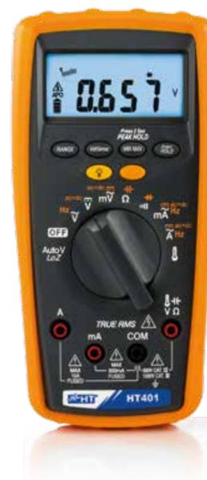
Multimetro digitale professionale in **TRMS a 6000 punti di misura** che esegue principalmente misure di **tensione AC/DC** e **corrente AC/DC**. Tra le molte funzionalità dello strumento sono comprese la modalità **AC+DC** utilizzata per considerare anche le **componenti continue eventualmente sovrapposte al segnale alternato** e la misura delle tensione AC in condizioni di **bassa impedenza (LoZ)** al fine di **ridurre le influenze** nella misura **tra conduttori adiacenti**.
