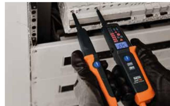
Misura della tensione tramite la separazione dei puntali.
