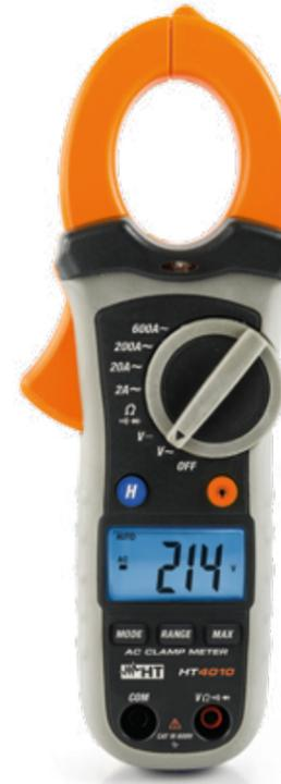
La pinza amperometrica HT4010 può effettuare misure di **Corrente in AC fino a 600A** e **Tensione AC/DC, Resistenza, Continuità** e **Prova Diodi**. Lo strumento dispone di un sensore interno in grado rilevare, tramite accensione di un LED e un cicalino, la presenza di tensione AC in un punto senza contatto. Lo strumento è conforme alla **IEC/EN61010-1** in **CAT III 600V** ed è ideale per misure sia in ambienti civili sia industriali.
