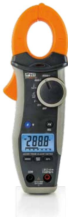
HT9015 è progettata per la misura di **Corrente AC/DC fino a 600A** e **Tensione AC/DC fino a 1000V** in **TRMS** nel raggiungimento della **CAT IV 600V** e **CAT III 1000V** in accordo allo standard di **sicurezza IEC/EN61010-1**. La pinza è provvista di un display a **6000 punti di misura** con **backlight** e **bargraph** in modo da eseguire semplici letture anche in ambienti scarsamente illuminati. HT9015 esegue anche misure di **Resistenza, Frequenza, Capacità e Temperatura con sonda K**.
