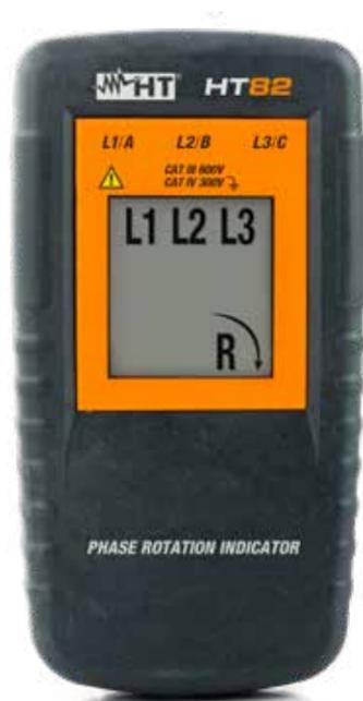
HT82 è uno strumento portatile per la visualizzazione del **senso ciclico delle fasi a 3 terminali** in un sistema **trifase** generico. Lo strumento fornisce una **indicazione "R"** in caso di **senso ciclico corretto** o **"L"** in caso di **senso ciclico non corretto**.
