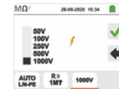
Selezione tensione di prova e valore limite minimo su misura MQ.
