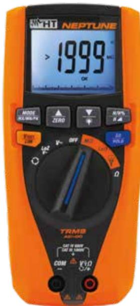
**NEPTUNE** è uno strumento innovativo che, oltre ad essere usato come potente multimetro per misure in **TRMS**, consente di realizzare test di sicurezza elettrica (Isolamento e continuità) in accordo alle prescrizioni della normativa CEI 64-8. È realizzato in CAT IV a 600V, con funzione autorange e display retroilluminato. Il design è estremamente moderno, accattivante ma allo stesso tempo ergonomico per offrire il massimo della praticità nell'utilizzo.
