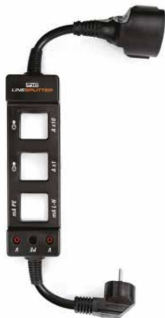
LINESPLITTER è un accessorio indispensabile tutte le volte che si deve misurare l'assorbimento di corrente/potenza o la corrente di dispersione di un carico monofase alimentato a spina (max 16A). **Questo accessorio separa fra loro i conduttori attivi ed il conduttore di protezione rendendo pertanto direttamente accessibili a strumentazione idonea (pinze amperometriche, pinze per la misura di corrente di dispersione, pinze wattmetriche, analizzatori di rete) i seguenti punti di misura:**
