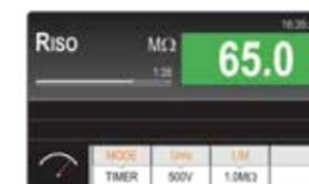
Misura di resistenza di isolamento.
