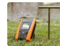
Misura della resistenza di terra con metodo voltamperometrico.
