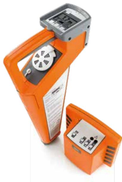
Il modello è costituito da un **Trasmittitore** e da un **Ricevitore** che sfruttano il principio della **propagazione del campo elettromagnetico** su un mezzo attraversato da un segnale opportunamente generato con diverse tipologie di accoppiamento. E' utilizzato principalmente per **localizzare tubazioni metalliche** o **cavi interrati**.
