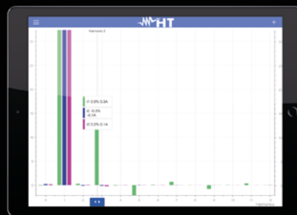
Armoniche di corrente e tensione.
