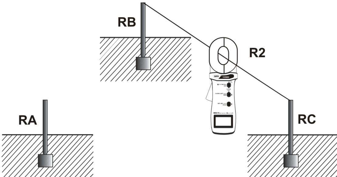
Fig. 12: Metodo a tre punti: secondo test R2
