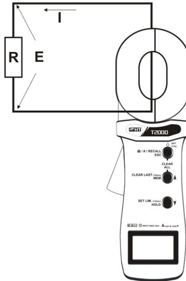
Fig. 6: Misura della resistenza dell'anello
