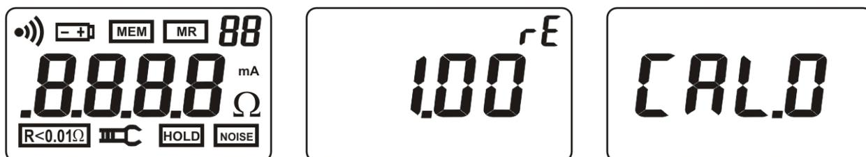
Fig. 2: Sequenza videate all'accensione dello strumento
