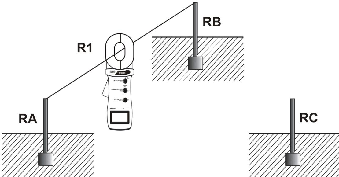
Fig. 11: Metodo a tre punti: primo test R1
