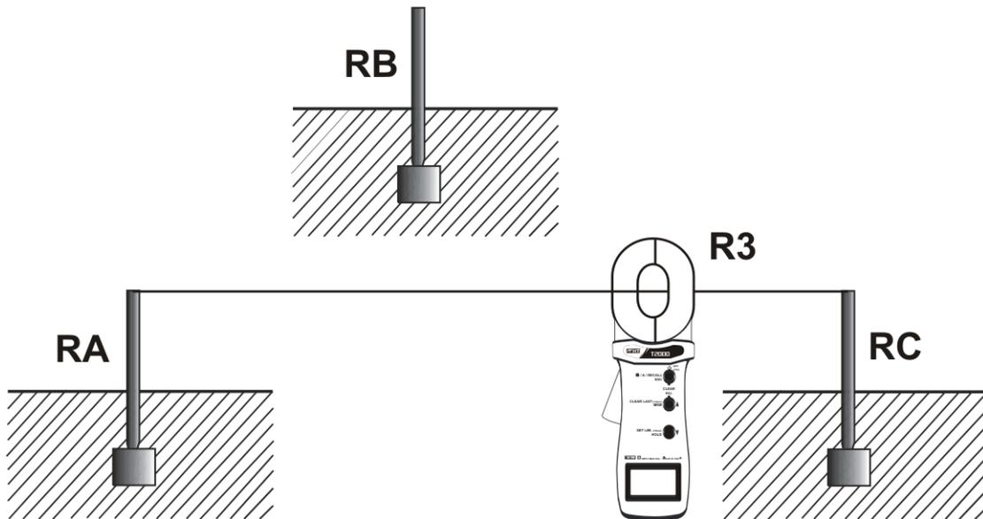
Fig. 13: Metodo a tre punti: terzo test R3
