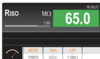
Misura di resistenza di isolamento
