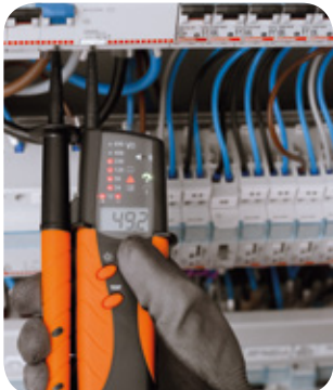
Misura di Tensione con visualizzazione valori a LED e Display.
