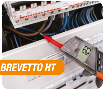
Misura del Senso Ciclico delle fasi con un singolo terminale anche sulla guaina.
