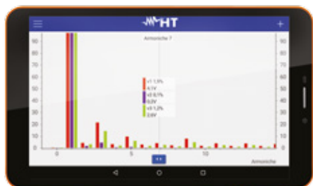
Esempio di visualizzazione Armoniche V-I
