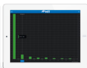
Armoniche di corrente e tensione.
