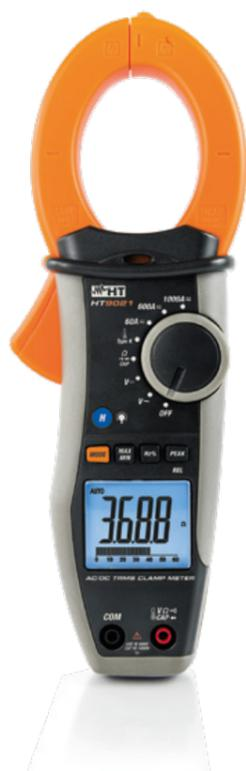
HT9021 è progettata per la misura di **corrente AC/DC fino a 1000A in TRMS** nel raggiungimento della **CAT IV 600V** e **CAT III 1000V** in accordo allo standard di **sicurezza IEC/EN61010-1**. La pinza è provvista di un display a **6000 punti di misura** con **backlight** e **bargraph** in modo da eseguire semplici letture anche in ambienti scarsamente illuminati. HT9021 esegue anche **misure di tensione fino a 1000V, Resistenza, Frequenza, Capacità e Temperatura con sonda K**.
