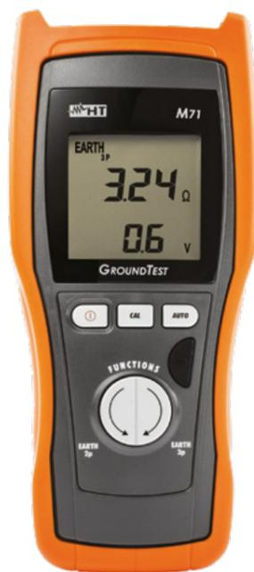
M71 è stato realizzato per effettuare le **misure resistenza di terra a 2-fili e 3-fili** con **metodo voltamperometrico** in conformità alla normativa CEI 64-8.
