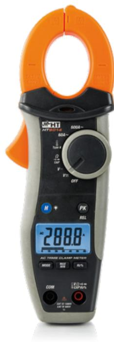
La pinza amperometrica HT9014 è progettata per la misura di **corrente AC fino a 600A e Tensione AC/DC fino a 1000V TRMS** per il raggiungimento della **CAT IV 600V e CAT III 1000V** in accordo alla norma **IEC/EN61010-1**. La pinza è dotata di un ampio **display retroilluminato a 6000 punti di misura** e di una funzione di autospegnimento per preservare la durata della batteria.
