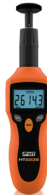
HT2236 è un contagiri digitale per misure della velocità di parti meccaniche rotanti (dischi, alberi motore, ecc...) sia a contatto sia senza contatto sfruttando l'emissione di un fascio luminoso trasmesso e riflesso dall'oggetto in prova.
