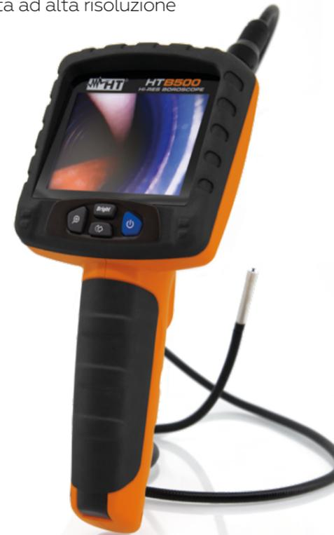
Il modello HTB500 è un boroscopio digitale portatile che consente l'esecuzione di ispezioni all'interno di parti di oggetti non fisicamente accessibili (tipicamente macchine rotanti) e non visibili ad occhio nudo. Lo strumento utilizza una sonda esterna impermeabile con 4 LED ad alta luminosità e una fotocamera in modo da ottenere un'immagine ad elevata risoluzione a display.
