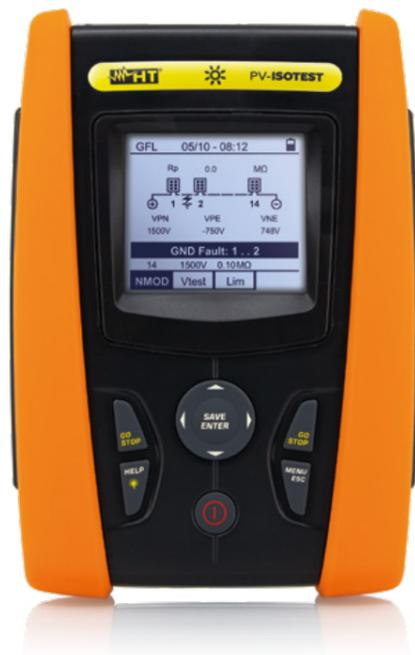
**PV-ISOTEST** rappresenta una vera innovazione, in quanto è in grado di effettuare la misura di isolamento di un modulo, di una stringa o di un intero campo fotovoltaico **fino a 1500V DC** in accordo alla normativa IEC/EN62446. Tramite la nuova **funzione GFL (Ground Found Locator)** lo strumento fornisce l'esatta indicazione della posizione di un eventuale singolo guasto di scarso isolamento **su una stringa** dell'impianto FV, dovuto, ad esempio, ad infiltrazioni d'acqua o umidità.
