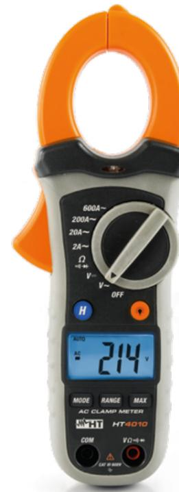
La pinza amperometrica HT4010 può effettuare misure di **Corrente in AC fino a 600A** e **Tensione AC/DC, Resistenza, Continuità e Prova Diodi**. Lo strumento dispone di un sensore interno in grado rilevare, tramite accensione di un LED e un cicalino, la presenza di tensione AC in un punto senza contatto. Lo strumento è conforme alla **IEC/EN61010-1** in **CAT III 600V** ed è ideale per misure sia in ambienti civili sia industriali.
