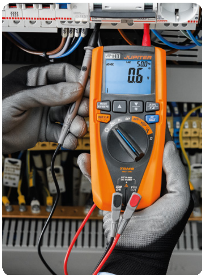
Azzeramento Tensione parassita.
