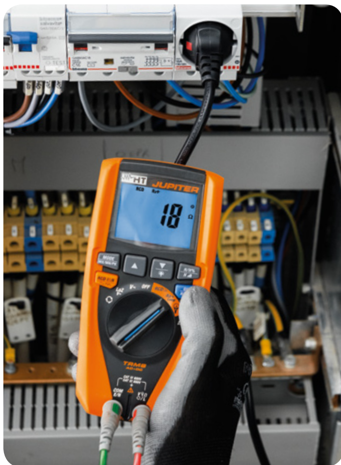
Misura resistenza globale di terra.
