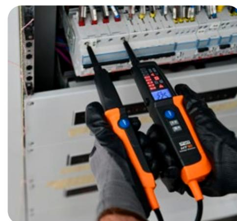
Misura della tensione tramite la separazione dei puntali.
