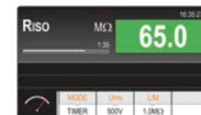
Misura di resistenza di isolamento.
