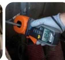
Misura resistenza di terra con pinza T2100.
