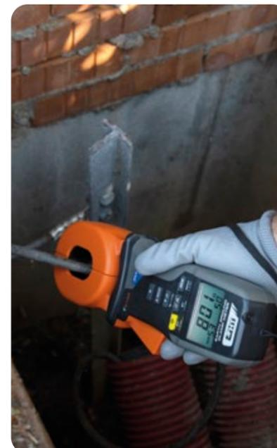
Misura della resistenza di Terra con Pinza T2100.
