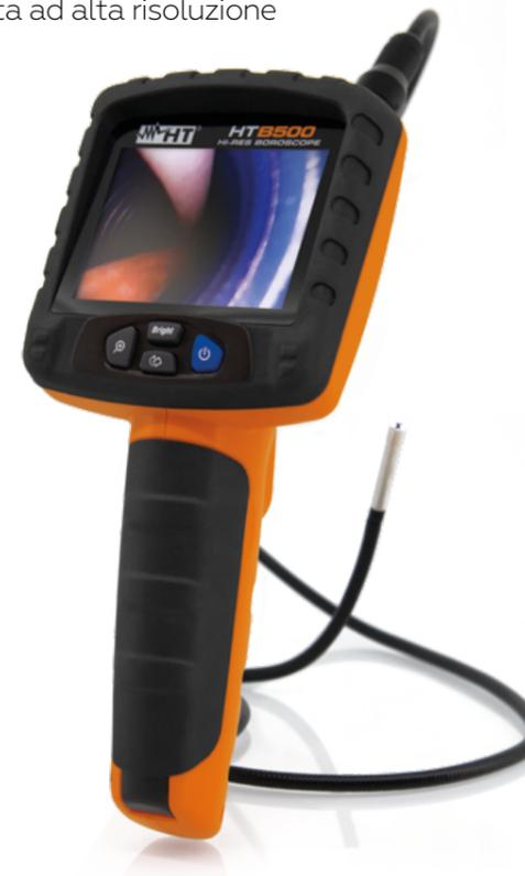
Il modello HTB500 è un boroscopio digitale portatile che consente l'esecuzione di ispezioni all'interno di parti di oggetti non fisicamente accessibili (tipicamente macchine rotanti) e non visibili ad occhio nudo. Lo strumento utilizza una sonda esterna impermeabile con 4 LED ad alta luminosità e una fotocamera in modo da ottenere un'immagine ad elevata risoluzione a display.
