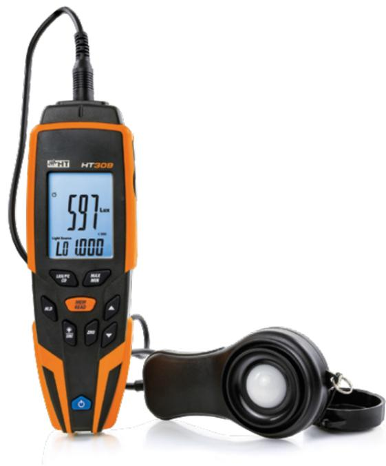
Il modello **HT309** è un **luxmetro digitale** per la misura dell'illuminamento fino a **400kLux** tramite sensore a fotodiode al silicio. Il modello consente inoltre la misura dell'**illuminamento di sorgenti a LED con vari colori** impostando i **relativi fattori correttivi**, la **misura dell'intensità luminosa** (espressa in Candele) e il **salvataggio dei risultati nella memoria interna**.
