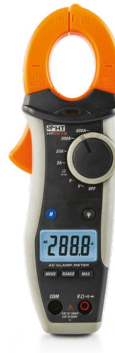
La pinza amperometrica HT9012 è progettata per la misura di **corrente AC fino a 600A e Tensione AC/DC fino a 1000V** per il raggiungimento della **CAT IV 600V e CAT III 1000V** in accordo alla norma **IEC/EN61010-1**. La pinza è dotata di un ampio **display retroilluminato a 6000 punti di misura** e di una funzione di autospegnimento per preservare la durata della batteria.
