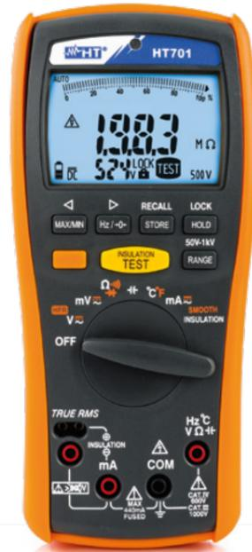
Multimetro professionale **TRMS** a **10.000 punti di misura** e misuratore di **resistenza di isolamento** con **tensione di prova selezionabile** tra **50, 100, 250, 500, 1000VDC**. HT701 è in grado di salvare i risultati delle misure nella propria **memoria interna** ed è progettato in accordo con la normativa di **sicurezza IEC/EN61010-1** in **CAT III 1000V** e **CAT IV 600V** con protezione in doppio isolamento.
