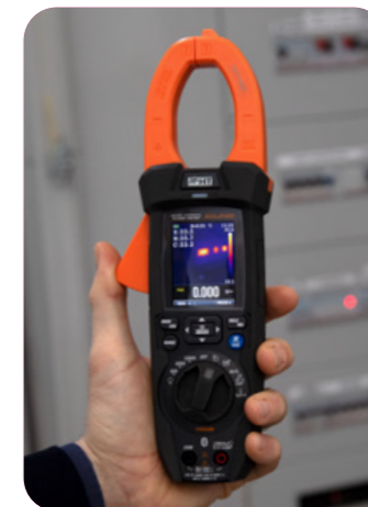
Verifica termografica con puntatore laser
