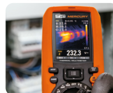
Analisi Termografica del Quadro Elettrico.
