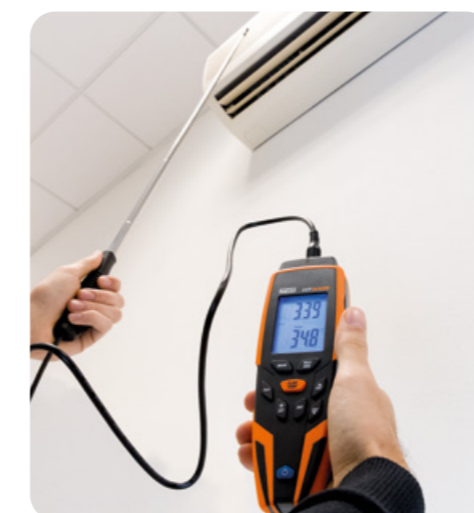
Misura di velocità e temperatura dell'aria con sonda telescopica di HTA105
