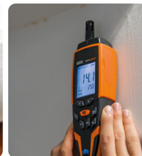
Misura umidità dei materiali con sensore integrato dell'HTA107 (Foto: misura diretta su di una parete apparentemente umida)
