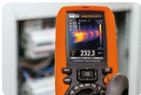
Analisi Termografica del Quadro Elettrico.
