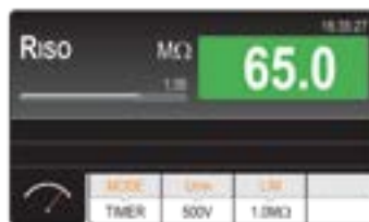
Misura di resistenza di isolamento
