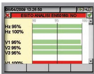
Visualizzazione grafica a istogrammi dei dati dell'analisi EN50160
