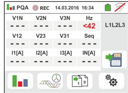
2. Toccare lo schema interattivo per impostare il tipo di collegamento tra quelli descritti nel § 6.3.1. Notare la descrizione nella parte bassa del display.
