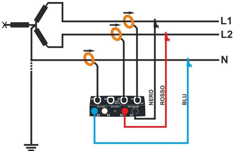
Fig. 16: Collegamento per misura su impianto Bifase  $3\phi$ -2EI.  $\frac{1}{2}$  – sistemi USA
