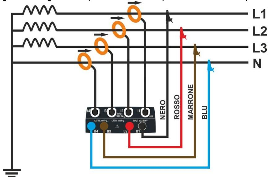
Fig. 10: Collegamento per misura su impianto Trifase **3φ-4FILI**
