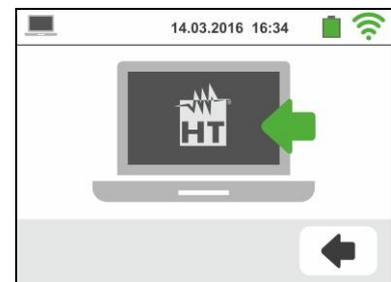
2. Abilitare la connessione WiFi sul PC di destinazione (ex: tramite uso di una chiavetta WiFi installata e collegata ad una porta USB) e connettersi alla rete WiFi resa disponibile dallo strumento (nome rete "VEGA74\_XXXXXX" in cui XXXXXX è il numero di serie dello strumento)
