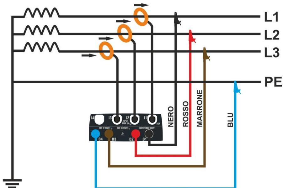
Fig. 11: Collegamento per misura su impianto Trifase **3φ-3FILI**
