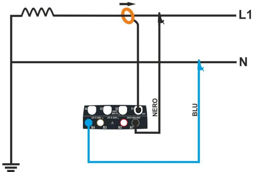
Fig. 9: Collegamento per misura su impianto Monofase **1φ-2FILI**
