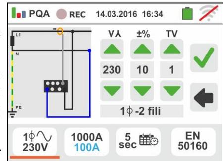
3. Spostare i riferimenti delle barra scorrevole per selezionare le opzioni relative alla scelta del tipo di pinza per la misura delle correnti di fase e della corrente di neutro (evidenziata in colore azzurro) considerando che **le pinze possono essere di tipo diverso** tra le opzioni:
