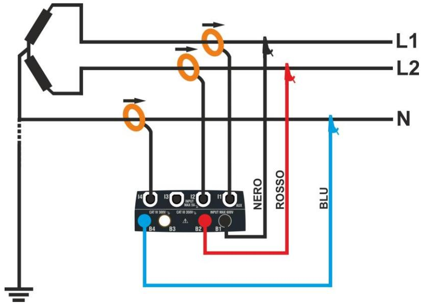
Fig. 15: Collegamento per misura su impianto Bifase  $3\phi$ -Y Aperta – sistemi USA
