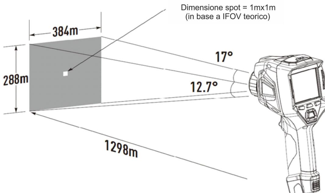
Fig. 52: Rappresentazione del campo visivo FOV dello strumento
