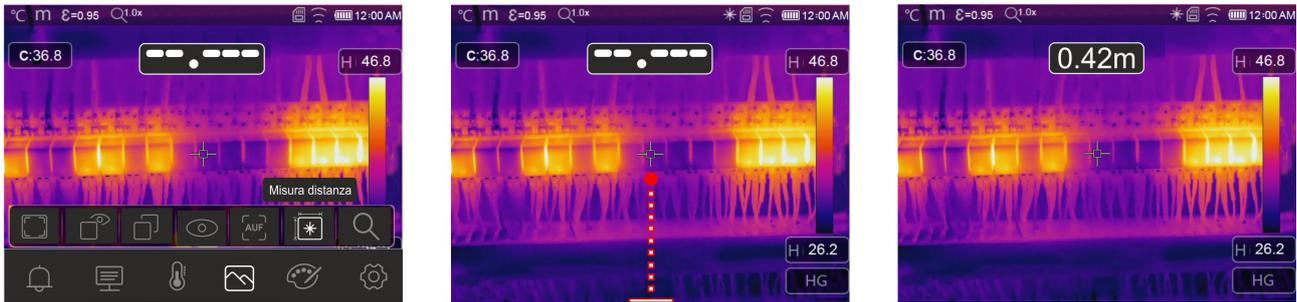
Fig. 37: Funzione misura distanza con puntatore laser
