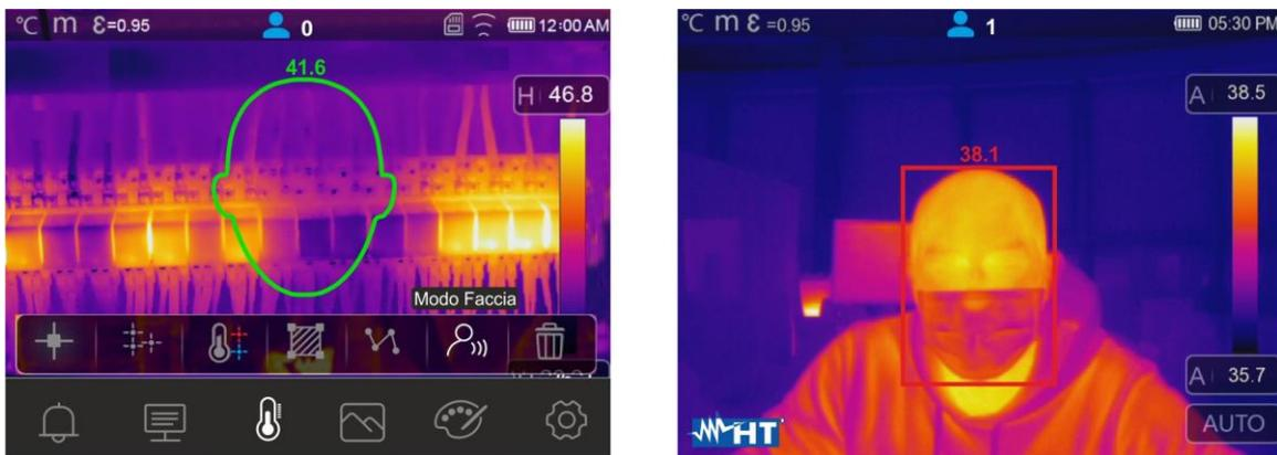
Fig. 49: Visualizzazione condizione di allarme nella funzione Screening
