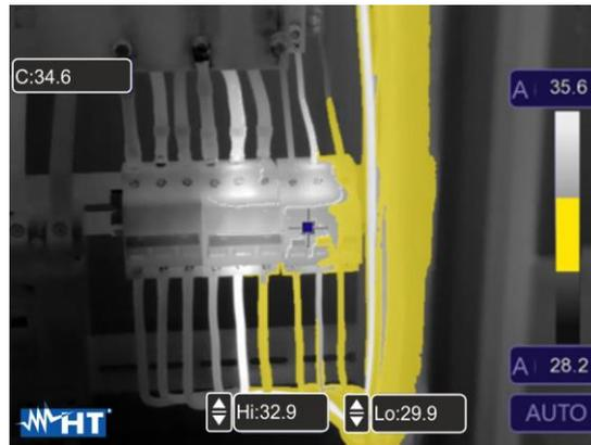
Fig. 39: Selezione isoterma Allarme intervallo Temp.
