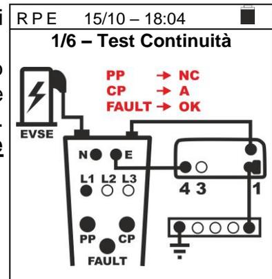
6. Premere il tasto **GO/STOP**. La videata a lato è mostrata a display. Il test RPE è eseguito dallo strumento **solo in modo STD**. Impostare il valore della soglia limite ed eseguire la calibrazione dei cavi di misura come mostrato nel § 6.3
