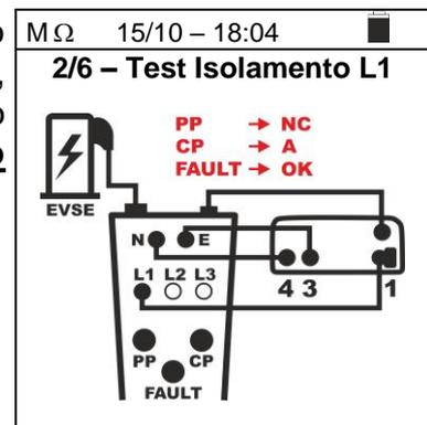
14. Premere il tasto **GO/STOP**. La seguente videata è mostrata a display. Il test è eseguito dallo strumento solo in modo AUTO in sequenza tra i conduttori L-N, L-PE e N-PE. Fare riferimento al § 6.5 per la descrizione sull'impostazione dei parametri di prova.
