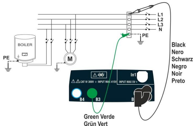
Fig. 18: Isolamento tra L-PE tramite cavi singoli e puntale remoto (modo TMR)
