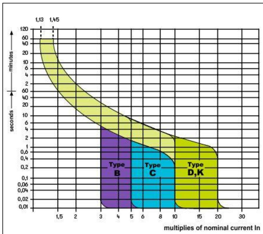
Fig. 45: Curve di intervento protezioni magnetotermiche (MCB)
