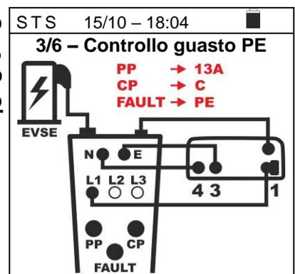
54. Premere il tasto **GO/STOP** per attivare il test **sullo stato PE**. La seguente videata è mostrata a display. Notare la presenza dello stato **“PE GUASTO”** in corrispondenza della posizione **“STATO”**
