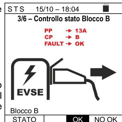
Utilizzare i tasti ◀, ▶ per selezionare l'opzione "OK" in caso di esito positivo e premere il tasto **GO/STOP** per proseguire con il test (vedere punto 35) o l'opzione "NO OK" e premere il tasto **GO/STOP** per **terminare la sequenza di test**
