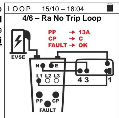
66. Il test è eseguito dallo strumento **solo in modo "Ra NoTrip 3-fili"** Fare riferimento al § 6.7.9 per la descrizione sull'impostazione dei parametri di prova relativamente alla corrente di intervento dell'RCD del sistema EVSE e al § 6.7.2 per la calibrazione preliminare dei terminali di misura.
