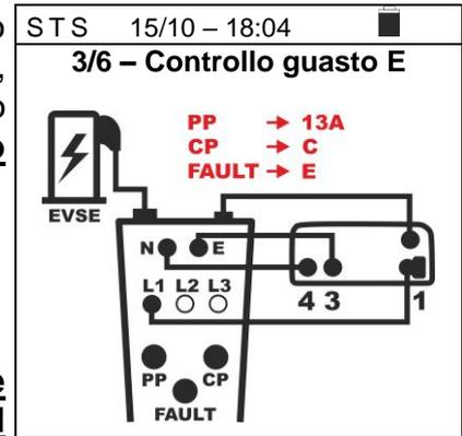
60. Premere il tasto **GO/STOP** per attivare il test **sullo stato E**. La seguente videata è mostrata a display. Notare la presenza dello stato **"GUASTO E"** in corrispondenza della posizione **"STATO"**
