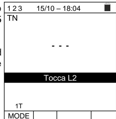
6. Lo strumento emette un suono lungo fino a quando non è presente la tensione di ingresso. Al termine del test, se la sequenza delle fasi rilevata è **corretta**, lo strumento visualizza una videata come quella a lato (risultato "**123**") e il messaggio "**OK**"
