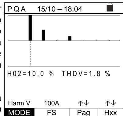
Il grafico a istogramma delle ampiezze percentuali della fondamentale e delle armoniche di tensione VL-N o corrente dal **valore DC fino al 25° ordine** (il valore della fondamentale H01 è sempre considerato pari al 100% e non visualizzato) oltre al valore della THD% (vedere § 12.12) sono mostrati a display. I seguenti comandi sono disponibili:
