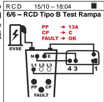
84. Il test è eseguito dallo strumento considerando solo RCD di tipo Generale STD (G), di tipo B/B+ e in modalità Rampa (▲) 0° (==/==+), non visualizzazione della tensione di contatto  $U_t$ , corrente nominale selezionabile tra i valori 6,10,30,100,300,500,650mA oppure tipo CCID (== ↑) corrente nominale selezionabile tra i valori 5,20mA Fare riferimento al § 6.6.4 per la descrizione sull'impostazione dei parametri di prova
