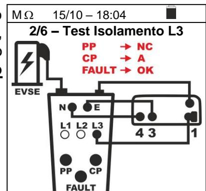
23. Premere il tasto **GO/STOP** sullo strumento. Lo strumento avvia la misura sequenziale automatica della resistenza di isolamento tra **L3-N**, **L3-PE** e **N-PE** rispettivamente visualizzando il messaggio "**Misura...**". Lo strumento visualizza sul display il messaggio "**OK**" in caso di esito positivo delle prove (valore superiore alla soglia limite minima impostata).
