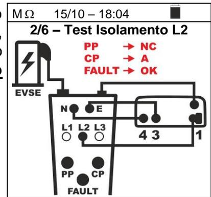
21. Premere il tasto **GO/STOP** sullo strumento. Lo strumento avvia la misura sequenziale automatica della resistenza di isolamento tra **L2-N** e **L2-PE** rispettivamente visualizzando il messaggio "**Misura...**". Lo strumento visualizza sul display il messaggio "**Collegare fase L3**" in caso di esito positivo delle prove (valore superiore alla soglia limite minima impostata).
