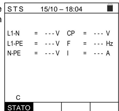
43. Premere il tasto **GO/STOP**. Il risultato delle misure è mostrato nella videata a fianco. Lo strumento visualizza sul display il messaggio "**OK**" in caso di esito positivo delle prove (vedere Tabella 3)
