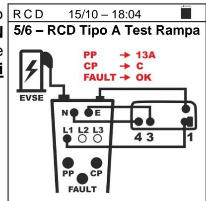
77. Il test è eseguito dallo strumento considerando **solo RCD di tipo Generale STD (G), di tipo A/F in modalità Rampa (▲) 0° (ΛΛ/∞↑), non visualizzazione della tensione di contatto Ut, corrente nominale selezionabile tra i valori 6,10,30,100,300,500,650mA oppure tipo CCID $\sim$  (▲) corrente nominale selezionabile tra i valori 5,20mA** Fare riferimento al § 6.6.4 per la descrizione sull'impostazione dei parametri di prova
