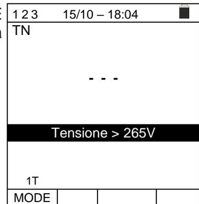
3. Se tra l'inizio della prova e l'acquisizione della prima tensione o tra l'acquisizione della prima e della seconda tensione è trascorso un tempo superiore a circa 10s, lo strumento visualizza una videata come quella a lato. È necessario ripetere il test
