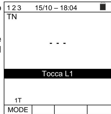
4. Lo strumento emette un suono lungo fino a quando non è presente la tensione di ingresso. Al termine dell'acquisizione della fase L1, lo strumento è in attesa del segnale sulla fase L2 e mostra il simbolo di "**Rilascia L1**" come mostrato nella videata a lato
