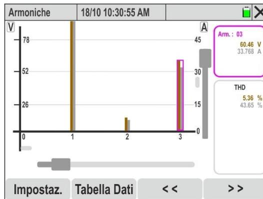
Fig. 57: Analisi armonica tensione e corrente per ogni singola fase
