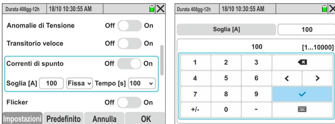
Fig. 34: Attivazione/disattivazione registrazione correnti di spunto
