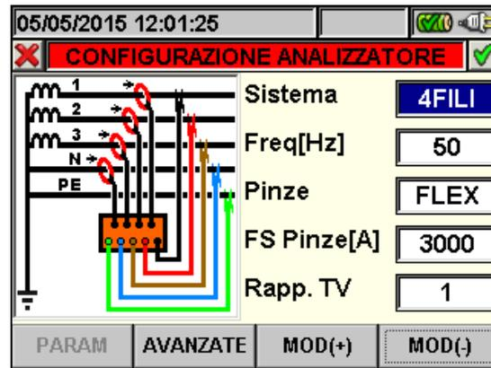
Fig. 44: Videata configurazione analizzatore per sistema Trifase 4-fili
