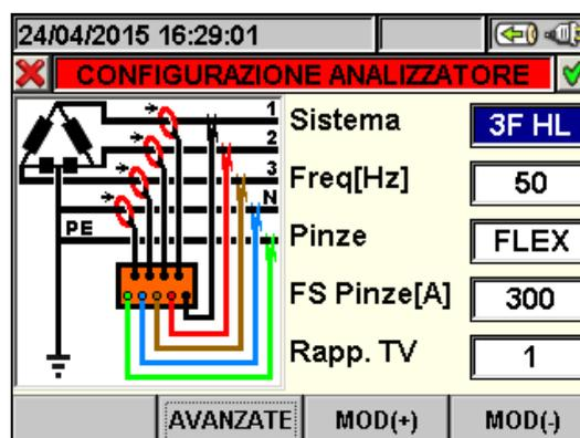
Fig. 51: Videata configurazione analizzatore per sistema Trifase 4-fili 3F HL
