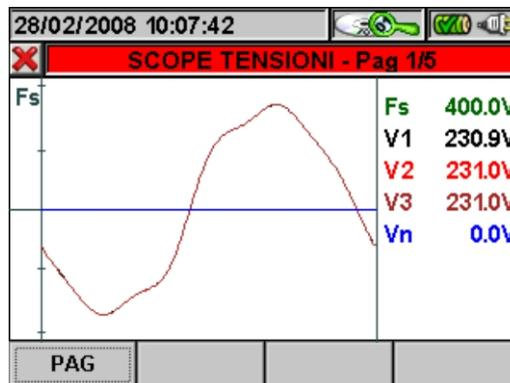
Fig. 107: Scope tensioni in sistema Trifase 4-fili
