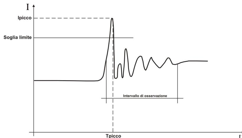
Fig. 131: Parametri corrente di spunto ad andamento oscillante
