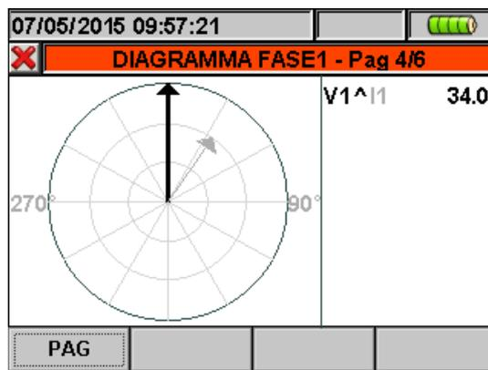
Fig. 42: Diagramma vettoriale tensione-corrente fase L1 per sistemi 4-fili
