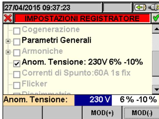
Fig. 66: Videata Anomalie di Tensione - impostazione parametri
