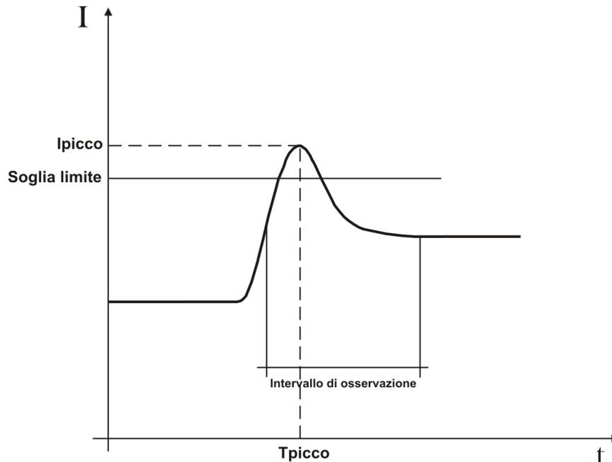
Fig. 130: Parametri corrente di spunto ad andamento standard
