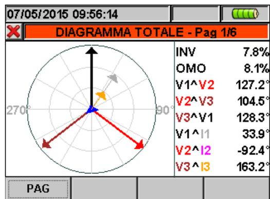
Fig. 39: Diagramma vettoriale totale per sistemi 4-fili
