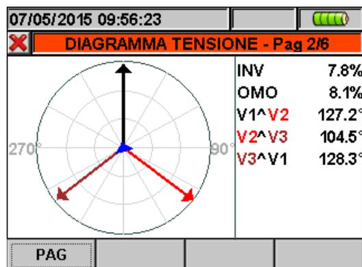
Fig. 40: Diagramma vettoriale tensioni per sistemi 4-fili
