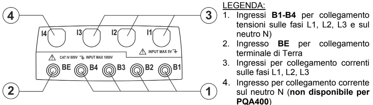
Fig. 2: Descrizione terminali di ingresso dello strumento
