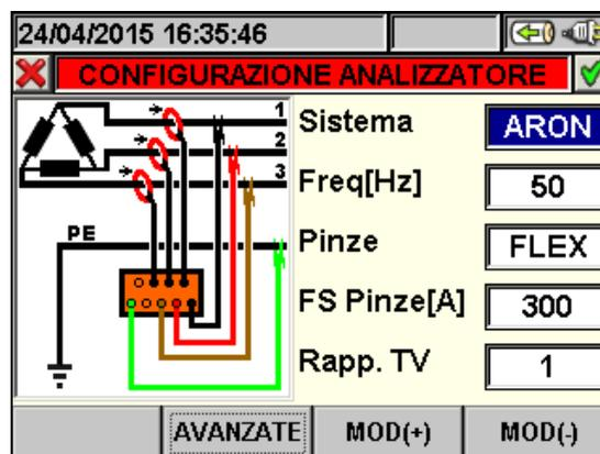
Fig. 46: Videata configurazione analizzatore per sistema Trifase ARON
