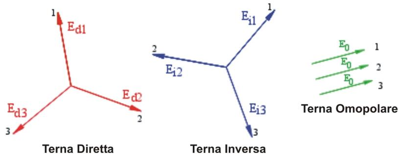
Fig. 132: Scomposizione di una terna di vettori
