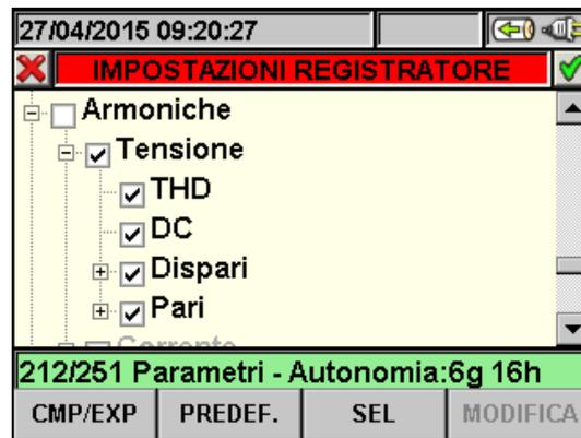
Fig. 61: Sottolivello Armoniche – selezione iniziale parametri
