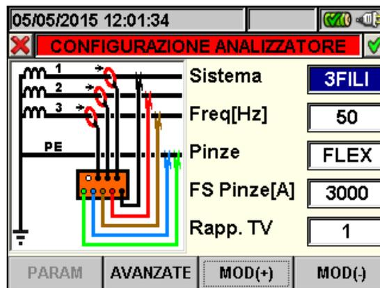
Fig. 45: Videata configurazione analizzatore per sistema Trifase 3-fili
