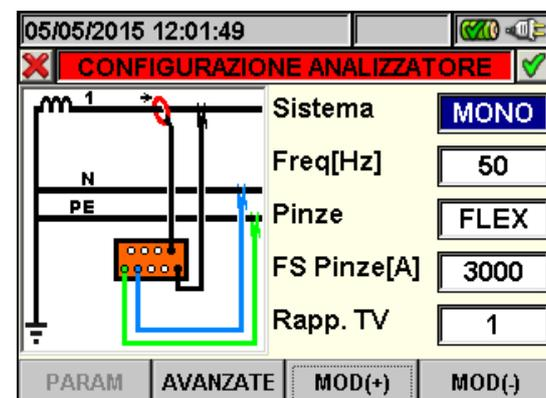
Fig. 47: Videata configurazione analizzatore per sistema Monofase
