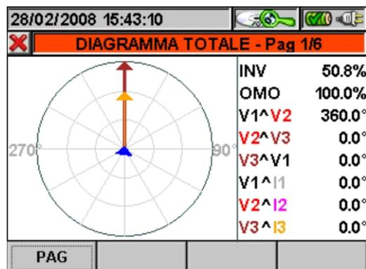
Fig. 109: Diagramma vettoriale totale in sistema Trifase 4-fili
