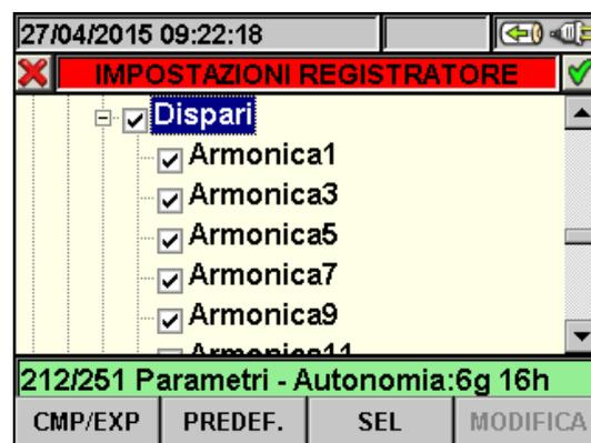
Fig. 62: Sottolivello Armoniche – selezione Armoniche Dispari
