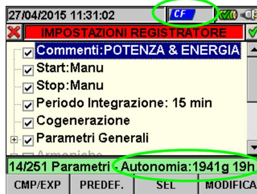
Fig. 115: Esempio di uso della memoria esterna - presenza Compact Flash
