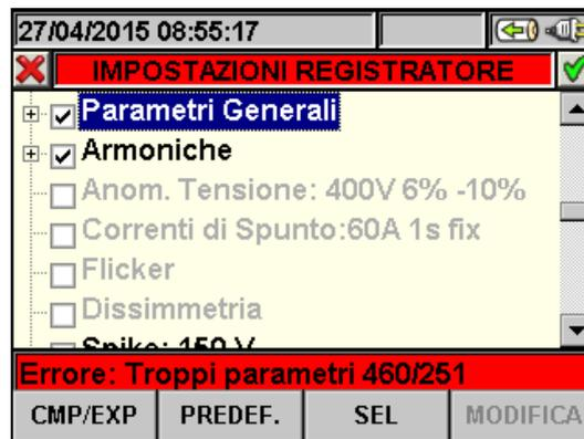
Fig. 59: Sezione Parametri Generali: troppi parametri selezionati
