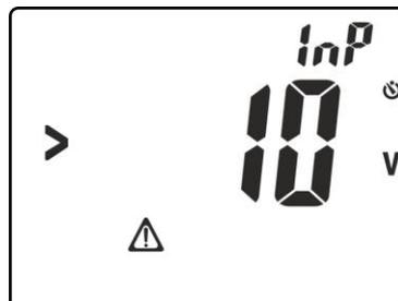
Fig. 27: Presenza tensione sui terminali di ingresso
