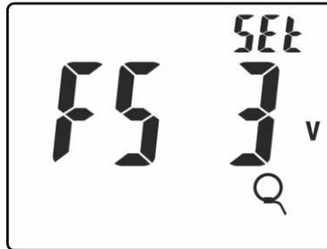
Fig. 5: Impostazione fondo scala pinza flessibile
