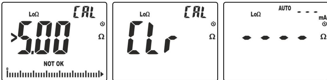
Fig. 34: Risultati azzeramento non eseguito correttamente
