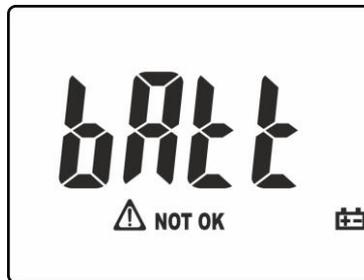
Fig. 43: Videata con indicazione batteria scarica
