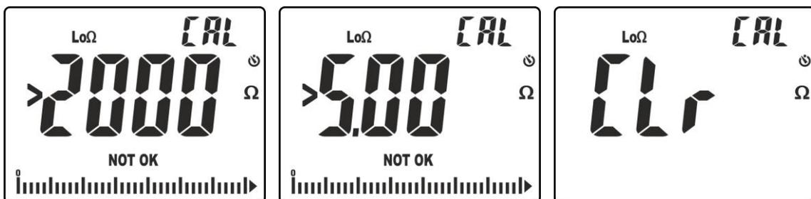
Fig. 35: Azzeramento di una calibrazione
