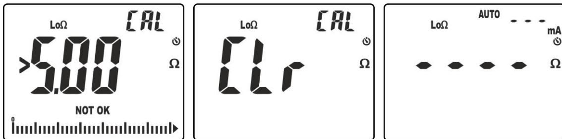
Fig. 34: Risultati azzeramento non eseguito correttamente
