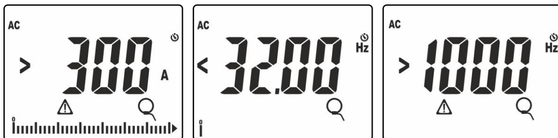
Fig. 39: Situazioni anomale sulla misura di corrente con trasduttori a pinza
