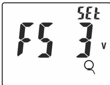
Fig. 5: Impostazione fondo scala pinza flessibile
