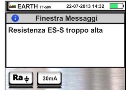
3. All'avvio della misurazione lo strumento verifica la continuità dei cavi di misura. **Qualora il circuito amperometrico (cavi blu H e nero E) sia interrotto o presenti una resistenza troppo elevata**, lo strumento visualizza una videata simile a quella a fianco
