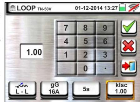
7. Scollegare, quando possibile, tutti i carichi connessi a valle del punto di misura in quanto l'impedenza dei suddetti utilizzatori potrebbe influenzare i risultati della prova. Connettere la spina shuko, i coccodrilli od il puntale remoto alla rete elettrica in accordo alle Fig. 16, Fig. 17, Fig. 18 e Fig. 20 nel punto più lontano possibile dalla protezione in esame
