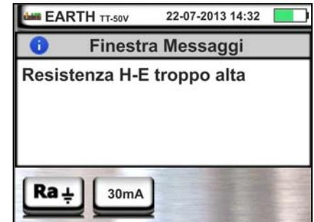
4. All'avvio della misurazione lo strumento verifica la situazione delle boccole B2 (S) e B3 (ES). In caso di inversione dei conduttori sull'impianto blocca la prova e mostra il messaggio visualizzato a lato
