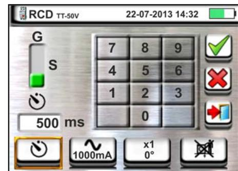
4. Spostare il riferimento della barra scorrevole sinistra selezionando il tipo di RCD tra le opzioni: **STD** (differenziali di tipo **Standard**) e (differenziali con toroide separato – con uso dell'accessorio opzionale RCDX10). Nel caso di selezione RCD con toroide separato lo strumento mostra la seguente videata
