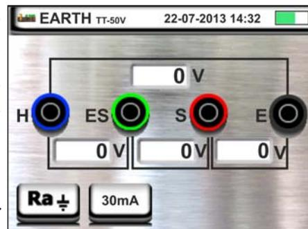
2. Spostare il riferimento della barra scorrevole nella posizione “**Ra**” per la selezione della misura di terra con metodo voltamperometrico, nella posizione per la misura di resistenza con uso di pinza opzionale T2100 (vedere § 6.7.3) o nella posizione “p” per la misura di resistività del terreno. Confermare la scelta tornando alla videata iniziale della misura.
