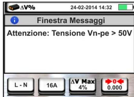
10. Qualora durante la misura sia rilevato un valore di impedenza di fine linea inferiore a quello di inizio linea lo strumento non effettua la prova e visualizza una videata come quella a fianco. Controllare lo stato della linea in esame
