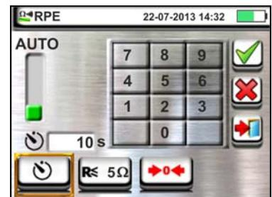
4. Toccare l'icona "R<=xxΩ" per impostare il valore limite massimo della resistenza su cui lo strumento esegue la comparazione con il valore misurato. La videata a fianco è mostrata a display
