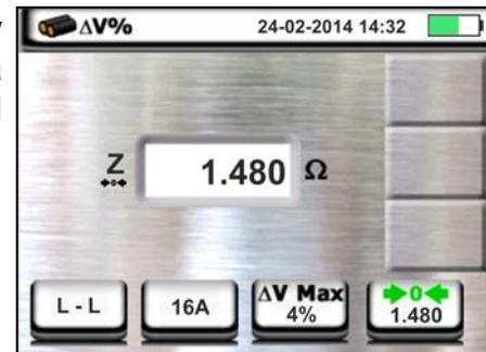
9. Collegare lo strumento nel punto finale della linea in esame in accordo alle Fig. 32 o Fig. 33 in modo da eseguire la misura di impedenza a fine linea **Z2**. La videata a fianco è mostrata a display. Notare la presenza a display del valore **Z1 (Offset)** precedentemente misurato
