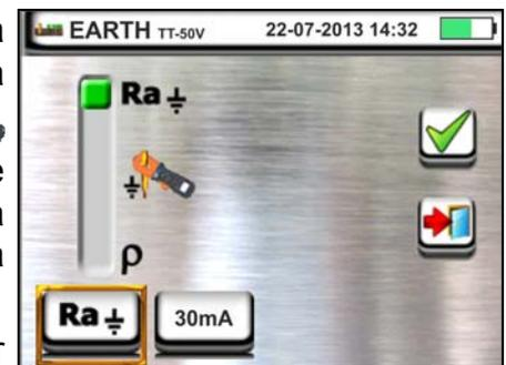
3. Spostare il riferimento della barra scorrevole nella posizione corrispondente al valore della corrente di intervento del differenziale RCD come mostrato nella videata a fianco. Sulla base di questa selezione e del valore della tensione di contatto (25V o 50V) lo strumento esegue il calcolo del valore limite della resistenza di terra (vedere § 12.7) che confronterà con il valore misurato al fine di fornire il risultato finale positivo o negativo della misura
