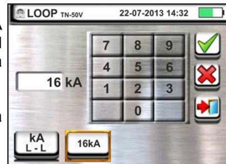
4. Scollegare, quando possibile, tutti i carichi connessi a valle del punto di misura in quanto l'impedenza dei suddetti utilizzatori potrebbe influenzare i risultati della prova. Connettere la spina shuko, i coccodrilli od il puntale remoto alla rete elettrica in accordo alle Fig. 16, Fig. 17, Fig. 18 e Fig. 20 nel punto più vicino possibile alla protezione in esame
