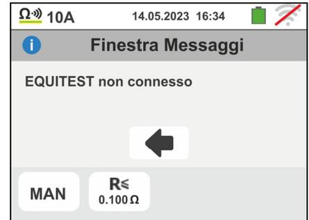
2. Se si cerca di impostare un valore di soglia limite sulla misura di resistenza esterno al campo di misura permesso la videata a lato è mostrata dallo strumento. Impostare il valore limite nel campo: **0.003Ω ÷ 0.500Ω**
