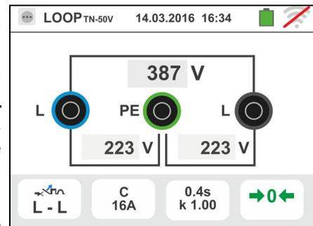
8. Premere il tasto **GO/STOP per alcuni secondi** oppure il tasto **START** sul puntale remoto. Durante tutta questa fase non scollegare i terminali di misura dello strumento dall'impianto in esame. In caso di esito positivo (corrente di cortocircuito minima interrotta dal dispositivo di protezione nel tempo indicato dalle selezioni eseguite) la videata a fianco è mostrata dallo
