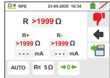
12. Al termine della prova **nella funzione "⋈"** nel caso in cui il valore della resistenza misurata risulti superiore al limite impostato, il valore è mostrato in rosso. L'indicazione ">1999Ω" indica il fuori scala dello strumento come mostrato nella videata a fianco
