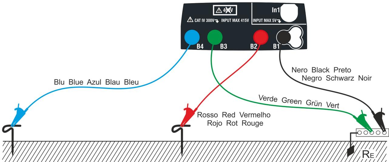
Fig. 28: Misura della resistenza di terra a 3 fili
