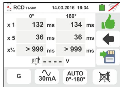
13 Al termine della prova, nel caso in cui il tempo di intervento una prova non risulti in accordo a quanto elencato in Tabella 7 lo strumento visualizza il simbolo
