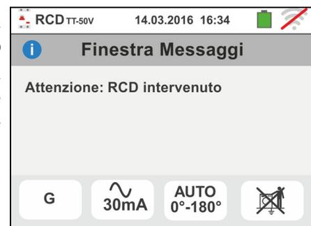
9. Se lo strumento rileva un potenziale pericoloso sul conduttore PE blocca la prova e visualizza il messaggio a lato. Controllare l'efficienza del conduttore PE e dell'impianto di terra. Tale messaggio può essere visualizzato anche per una pressione insufficiente del tasto **GO/STOP**
