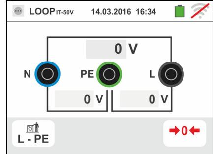
2. Spostare il riferimento della barra scorrevole sinistra selezionando l'icona per l'esecuzione della misura. Spostare il riferimento della barra scorrevole centrale selezionando l'opzione "L-PE". Automaticamente il riferimento della barra scorrevole destra si imposta nella posizione .
