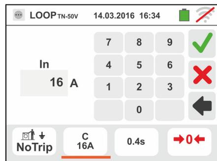
5. Spostare il riferimento della barra scorrevole selezionando il tempo di intervento della protezione tra le opzioni: **0.1s**, **0.2s**, **0.4s**, **1s**, **5s** (tutte le nazioni eccetto AUS/NZ) e **0.4s**, **5s** (protezione Fusibile per AUS/NZ), **0.4s** (protezione MCB per AUS/NZ)
