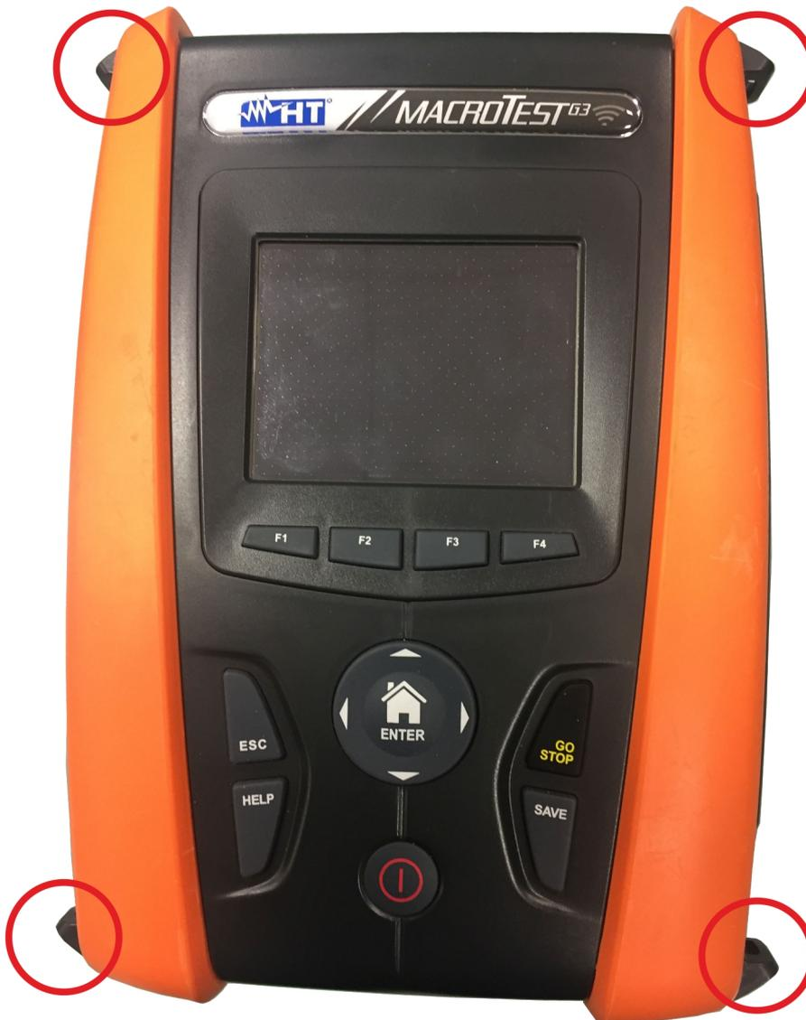
Fig. 42: Strumento con semigusci e ganci montati
