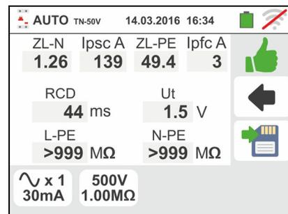
9. In caso di esito **positivo** delle tre prove eseguite in sequenza **NoTrip** (**ZL-N** e **ZL-PE < 199Ω**), **RCD** (vedere § 13.4) e **MΩ L/N-PE** lo strumento visualizza il simbolo e la videata a fianco è mostrata a display.
