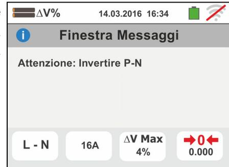
7. Qualora venga rilevato lo scambio tra i terminali di fase e PE lo strumento non effettua la prova e visualizza una videata come quella a fianco. Controllare il collegamento dei cavi di misura
