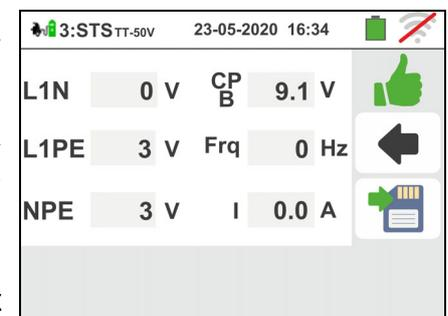
29 Nel caso in cui il test abbia esito negativo la videata come quella a fianco è mostrata a display. Il valore del errato del parametro è mostrato in rosso e il simbolo indica il risultato non ok della misura.
