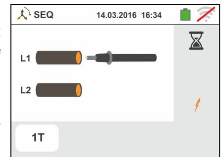
7. Il simbolo del puntale sulla fase L2 e la clessidra indicante la condizione di attesa del riconoscimento di una tensione superiore al limite massimo consentito
