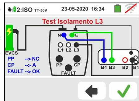
18 Il risultato delle misura dei **test L3PE e NPE** è mostrato nella videata a fianco. I valori delle reali tensioni di prova sono presenti a display. Il simbolo indica il risultato ok della misura.
