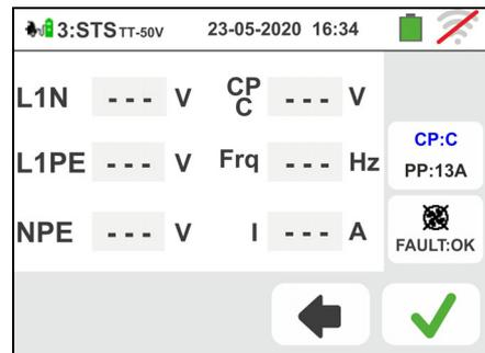
32 Il risultato delle misura è mostrato nella videata a fianco. Il simbolo indica il risultato ok della misura. Il simbolo indica anch'esso un risultato positivo della misura ma con valori esterni ai limiti presenti nella Tabella 4.
