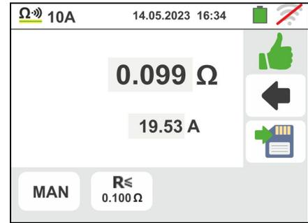
7. Al termine della prova, nel caso in cui il valore della resistenza misurata risulti superiore al limite impostato, la videata a fianco è mostrata a display
