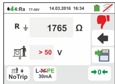
Premere il tasto **SAVE** o toccare l'icona
