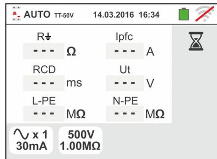
7. Premere il tasto **GO/STOP** per alcuni secondi oppure il tasto **START** sul puntale remoto per attivare la prova. Durante tutta questa fase non scollegare i terminali di misura dello strumento dall'impianto in esame. Nel caso di selezione **misura della corrente di intervento RCD** la videata a fianco è mostrata a display in cui l'icona della clessidra indica lo svolgimento del test
