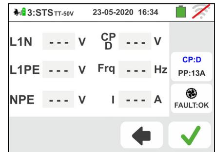
36 Il risultato delle misura è mostrato nella videata a fianco. Il simbolo indica il risultato ok della misura. Il simbolo indica anch'esso un risultato positivo della misura ma con valori esterni ai limiti presenti nella Tabella 4.
