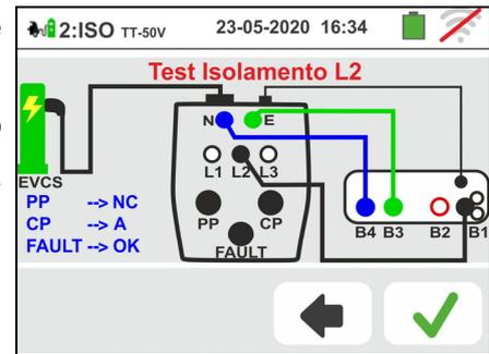
16 Il risultato della misura del **test L2PE** è mostrato nella videata a fianco. I valori delle reali tensioni di prova sono presenti a display. Il simbolo indica il risultato ok della misura.
