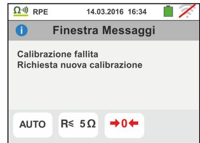
3. Qualora venga eseguito un reset della calibrazione dei cavi (eseguendo l'operazione con terminali aperti) lo strumento emette un segnale acustico prolungato e visualizza una videata come quella a fianco. L'icona è mostrata a display ad indicare il valore azzerato della calibrazione
