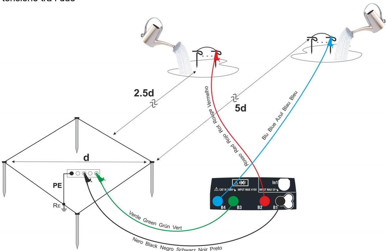
Fig. 47: Misura di terra per reti di terra di piccole dimensioni
