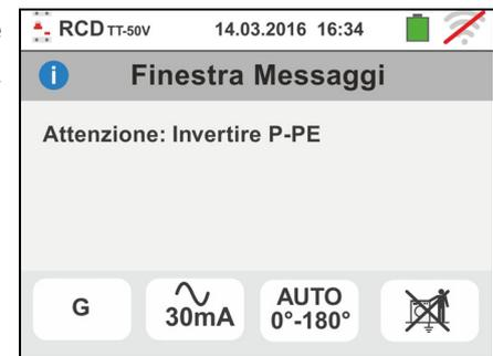
8. Qualora l'interruttore differenziale in esame intervenga durante la fase di pre-prova (eseguita in modo automatico dallo strumento prima di effettuare la prova selezionata), lo strumento non esegue il test e visualizza una videata come quella a fianco. Controllare che il valore impostato di IdN sia coerente con l'interruttore differenziale in esame e che tutti i carichi connessi a valle dello stesso siano scollegati
