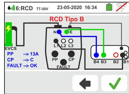
65 Il test è eseguito dallo strumento considerando solo RCD di tipo Generale STD (G), di tipo B/B+ o tipo DD e in modalità Rampa (▲) 0°. Toccare la seconda icona. La seguente videata è mostrata a display
