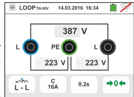
7. Premere il tasto **GO/STOP per alcuni secondi** oppure il tasto **START** sul puntale remoto. Durante tutta questa fase non scollegare i terminali di misura dello strumento dall'impianto in esame. In caso di esito positivo (corrente di cortocircuito minima interrotta dal dispositivo di protezione nel tempo indicato dalle selezioni eseguite) la videata a fianco è mostrata dallo strumento.
