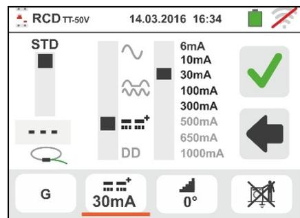
67 Il modo Rampa ▲ è fisso sullo strumento. Spostare il riferimento della barra scorrevole inferiore selezionando il tipo di visualizzazione della corrente di intervento durante la prova a Rampa tra le opzioni **“NOM” o “REAL”** (vedere § 6.3).
