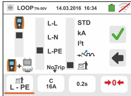
3. Spostare il riferimento della barra scorrevole selezionando il tipo di protezione (Fusibile di tipo **gG** o **aM** o magnetotermico MCB in curva **B**, **C**, **K**, **D**), (Fusibile di tipo **BS88-2**, **BS88-3**, **BS3036**, **BS1362** o magnetotermico MCB in curva **B**, **C**, **D** – nazione **UK**). Per nazione **AUS/NZ** magnetotermico MCB in curva **B**, **C**, **D**
