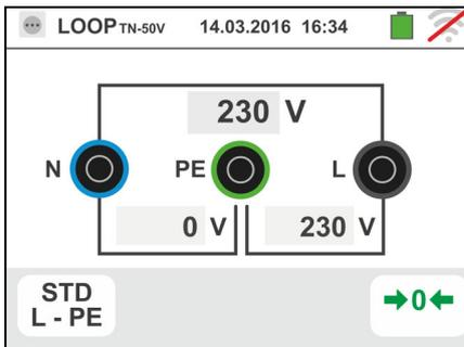
6. Il valore della corrente di cortocircuito presunta ( $I_{sc}$ ) è mostrato nella parte superiore del display mentre il valore dell'impedenza di Loop (L-L, L-N o L-PE) è presente nella parte inferiore del display. Premere il tasto **SAVE** o toccare l'icona per il salvataggio della misura (vedere § 7.1). La corrente di cortocircuito presunta ( $I_{sc}$ ) Standard (Std) è calcolata applicando la seguente formula:
