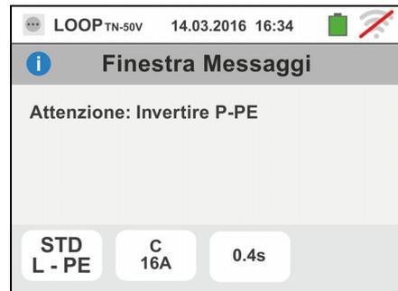
8. Qualora venga rilevata la presenza di una tensione pericolosa sul terminale PE lo strumento non effettua la prova e visualizza una videata come quella a fianco. Tale messaggio può essere visualizzato anche per una pressione insufficiente del tasto **GO/STOP**
