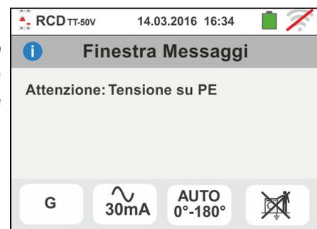
10. Se lo strumento rileva una tensione di contatto Ut pericolosa (superiore al limite impostato 25V o 50V) nella pre-prova iniziale non esegue il test e visualizza il messaggio a lato. Controllare l'efficienza del conduttore PE e dell'impianto di terra
