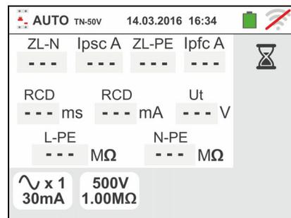
8. In caso di esito **positivo** delle tre prove eseguite in sequenza **NoTrip** (**ZL-N** e **ZL-PE < 199Ω**), **RCDX1** (vedere § 13.4) e **MΩ L/N-PE** lo strumento visualizza il simbolo e la videata a fianco è mostrata a display.
