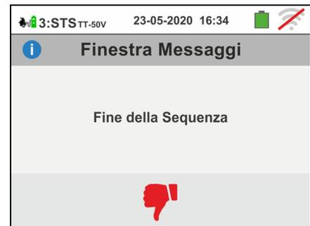
Test 4 → Misura resistenza globale di terra del sistema EVSE
