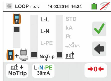
3. Spostare il riferimento della barra scorrevole sinistra selezionando il valore della corrente di intervento dell'RCD tra i valori: **6,10,30,100,300,500,650,1000mA**. Spostare il riferimento della barra scorrevole destra selezionando il tipo di collegamento tra le opzioni: **L-N-PE** (presenza conduttore di Neutro) o **L-X-PE** (assenza del conduttore di Neutro). Confermare le scelte tornando alla videata iniziale della misura
