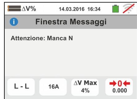
5. Se lo strumento rileva l'assenza del segnale sul terminale B3 (conduttore PE) fornisce la videata di avviso mostrata a lato e blocca lo svolgimento delle prove.
