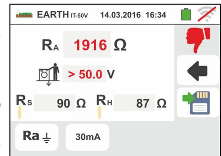
9. Per **misura di resistenza di terra nei sistemi TN** In caso di esito **positivo** (valore misurato **MINORE** del valore limite impostato) la videata a fianco è mostrata dallo strumento oltre al valore della resistenza di contatto della sonda di tensione ( $R_s$ ) e il valore della resistenza di contatto della sonda di corrente ( $R_h$ )
