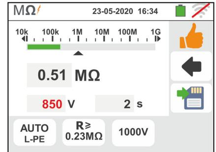
2. **Nella misura L/N-PE** qualora in uno o entrambi i test lo strumento misuri una resistenza superiore al limite impostato ma per la quale non riesce a generare la tensione nominale visualizza una videata come quella a fianco.
