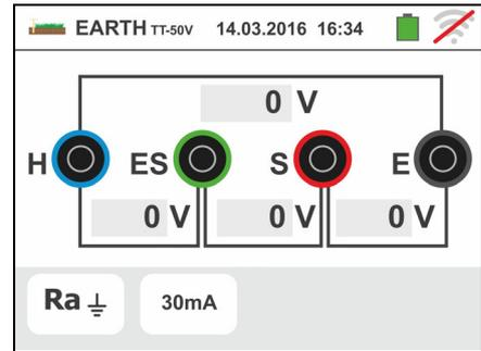
2. Spostare il riferimento della barra scorrevole nella posizione “**Ra**” per la selezione della misura di terra con metodo voltamperometrico, nella posizione per la misura di resistenza con uso di pinza opzionale T2100 (vedere § 6.7.3) o nella posizione “ $\rho$ ” per la misura di resistività del terreno. Confermare la scelta tornando alla videata iniziale della misura.
