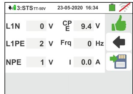
45 Nel caso in cui il test abbia esito negativo la videata come quella a fianco è mostrata a display. Il valore dell'errato del parametro è mostrato in rosso e il simbolo indica il risultato non ok della misura.
