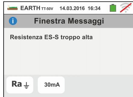
3. All'avvio della misurazione lo strumento verifica la continuità dei cavi di misura. **Qualora il circuito amperometrico (cavi blu H e nero E) sia interrotto o presenti una resistenza troppo elevata**, lo strumento visualizza una videata simile a quella a fianco
