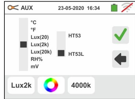
4. **Nel caso di sorgenti LED/Colorate** è necessario impostare il valore della corrispondente **temperatura di colore** (espressa in K) nel campo: **2500K ÷ 6500K** al fine di ottenere risultati di misura corretti.
