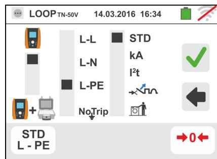
3. Scollegare, quando possibile, tutti i carichi connessi a valle del punto di misura in quanto l'impedenza dei suddetti utilizzatori potrebbe influenzare i risultati della prova
