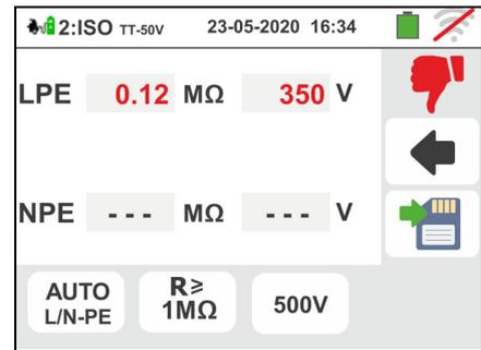
Premere il tasto **SAVE** o toccare l'icona
