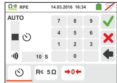
4. Toccare l'icona "R≤xxΩ" per impostare il valore limite massimo della resistenza su cui lo strumento esegue la comparazione con il valore misurato. La videata a fianco è mostrata a display. Toccare l'icona per azzerare il valore nel campo "R≤". Usare la tastiera virtuale per impostare il valore compreso tra **0.01Ω** e **9.99Ω**. Confermare la scelta tornando alla videata iniziale della misura. Notare la presenza del valore limite impostato
