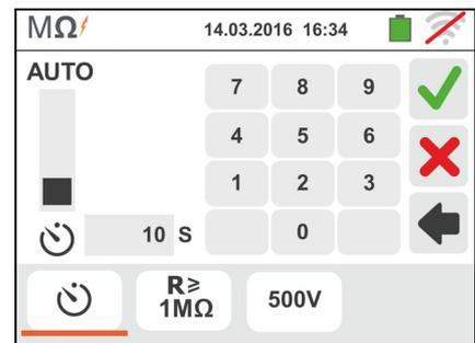
4. Toccare l'icona " $R \geq xx\Omega$ " per impostare il valore limite minimo della resistenza di isolamento su cui lo strumento esegue la comparazione con il valore misurato. La videata a fianco è mostrata a display
