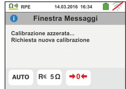
4. Qualora venga rilevato che la resistenza calibrata sia più elevata della resistenza misurata (ad esempio per uso di cavi diversi da quelli in dotazione), lo strumento emette un segnale acustico prolungato e visualizza una videata come quella a fianco. Eseguire un reset e operare una nuova calibrazione
