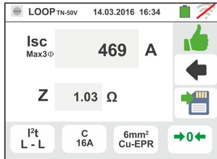
8. In caso di esito negativo della prova (corrente I<sub>sc</sub> trifase misurata nel caso L-L di figura NON sopportata dal cavo con le selezioni eseguite) la videata a fianco è mostrata dallo strumento
