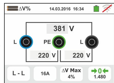
10 Premere il tasto **GO/STOP** sullo strumento per eseguire la misura dell'impedenza  $Z_2$  e completare la misura della caduta di tensione  $\Delta V\%$ . Durante tutta questa fase non scollegare i terminali di misura dello strumento dall'impianto in esame.
