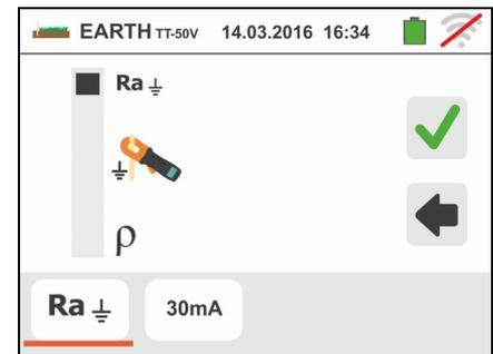
3. Spostare il riferimento della barra scorrevole nella posizione corrispondente al valore della corrente di intervento del differenziale RCD come mostrato nella videata a fianco. Sulla base di questa selezione e del valore della tensione di contatto (25V o 50V) lo strumento esegue il calcolo del valore limite della resistenza di terra (vedere § 13.7) che confronterà con il valore misurato al fine di fornire il risultato finale positivo o negativo della misura
