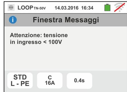
3. Se lo strumento rileva l'assenza del segnale sul terminale B1 (conduttore di fase) fornisce la videata di avviso mostrata a lato e blocca lo svolgimento delle prove
