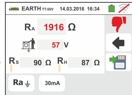
8. Per **misura di resistenza di terra nei sistemi IT** In caso di esito **negativo** (vedere § 13.9) la videata a fianco è mostrata dallo strumento in cui è presente il valore della tensione di contatto nel display secondario, il valore della resistenza di contatto della sonda di tensione ( $R_s$ ) e il valore della resistenza di contatto della sonda di corrente ( $R_h$ )
