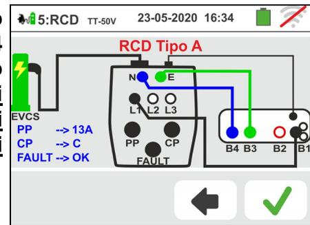
57 Il test è eseguito dallo strumento considerando **solo RCD di tipo Generale STD (G), di tipo A/F e in modalità Rampa (▲) 0°**. Toccare la seconda icona. La seguente videata è mostrata a display
