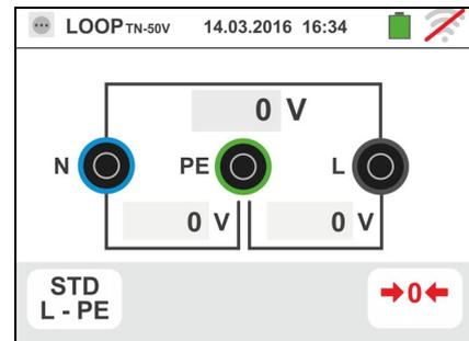
2. Spostare il riferimento della barra scorrevole sinistra selezionando l'icona per l'esecuzione della misura con il solo strumento oppure l'icona per l'esecuzione della misura con strumento + accessorio opzionale IMP57 (vedere § 6.4.12). Spostare il riferimento della barra scorrevole centrale selezionando l'opzione "L-L, L-N o L-PE". Spostare il riferimento della barra scorrevole destra selezionando l'opzione "STD". Confermare la scelta tornando alla videata precedente
