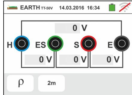
8. Spostare il riferimento della barra scorrevole nella parte sinistra per selezionare l'unità di misura della distanza tra le opzioni: **m** (metri) o **ft** (feet).
