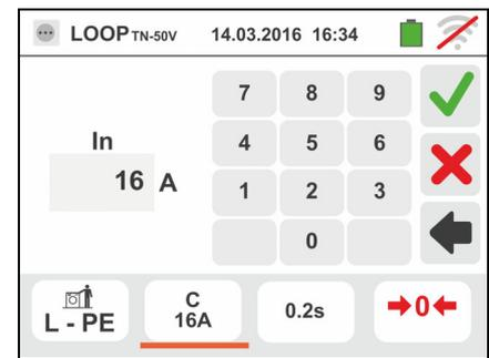
5. Spostare il riferimento della barra scorrevole selezionando il tempo di intervento della protezione tra le opzioni: **0.1s**, **0.2s**, **0.4s**, **1s**, **5s** (tutte le nazioni eccetto AUS/NZ e UK) e **0.4s**, **5s** (protezione Fusibile per UK), **0.4s** (protezione MCB per AUS/NZ)
