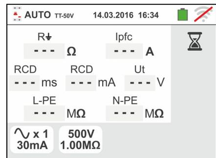
8. In caso di esito **positivo** delle tre prove eseguite in sequenza **NoTrip** (vedere § 13.8), **RCDX1** (vedere § 13.4) e **MΩ L/N-PE** lo strumento visualizza il simbolo e la videata a fianco è mostrata a display.
