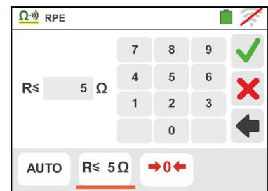
5. Eseguire, se necessario, la compensazione della resistenza dei terminali di misura collegando i cavi o il puntale remoto come indicato in Fig. 7
