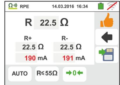
2. Qualora in modo lo strumento rilevi ai propri terminali una resistenza superiore a 5Ω azzerà il valore compensato e visualizza una videata come quella a fianco. L'icona è mostrata a display ad indicare il valore azzerato della calibrazione (eseguendo l'operazione con terminali aperti)
