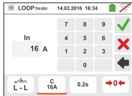
5. Spostare il riferimento della barra scorrevole selezionando il tempo di intervento della protezione tra le opzioni: **0.1s**, **0.2s**, **0.4s**, **1s**, **5s** (tutte le nazioni eccetto AUS/NZ e UK), **0.4s**, **5s** (opzione L-PE, protezione Fusibile per AUS/NZ e UK) e **0.4s** (opzione L-PE, protezione MCB per AUS/NZ). Confermare la scelta tornando alla videata iniziale della misura
