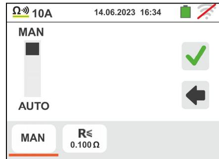
4. Toccare l'icona per azzerare il valore nel campo "Ω" e usare la tastiera virtuale per impostare il valore della resistenza limite massima usata dallo strumento per la valutazione del test di continuità nel campo: **0.003Ω ÷ 0.500Ω** in passi da **0.001Ω**. Confermare la scelta tornando alla videata precedente
