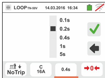
6. Scollegare, quando possibile, tutti i carichi connessi a valle del punto di misura in quanto l'impedenza dei suddetti utilizzatori potrebbe influenzare i risultati della prova. Eeguire la calibrazione preliminare dei terminali di misura come descritto nel § 0. Connettere la spina shuko, i coccodrilli od il puntale remoto alla rete elettrica in accordo alle Fig. 18, Fig. 19, Fig. 20 e Fig. 22 nel punto più lontano possibile dalla protezione in esame
