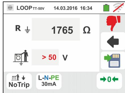
Notare la presenza del risultato della misura di tensione di contatto evidenziato in rosso
