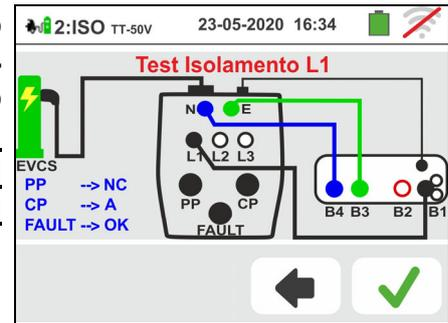
12 Il test è eseguito dallo strumento **solo in modo AUTO L/N-PE**. Fare riferimento al § 6.2.2 per la descrizione sull'impostazione dei parametri di prova.
