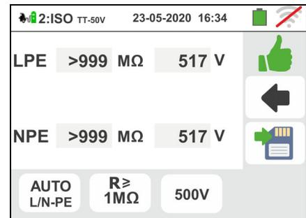
14 **Per sistemi EVSE Trifase** il risultato della misura del **primo test L1PE** è mostrato nella videata a fianco. I valori delle reali tensioni di prova sono presenti a display. Il simbolo indica il risultato ok della misura.
