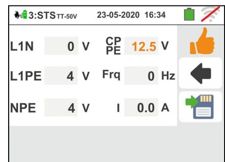
41 Nel caso in cui il test abbia esito negativo la videata come quella a fianco è mostrata a display. Il valore del errato del parametro è mostrato in rosso e il simbolo indica il risultato non ok della misura.
