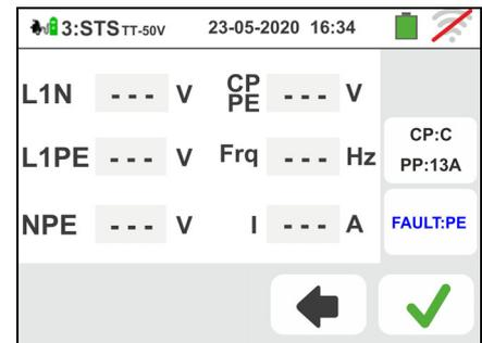
40 Il risultato delle misura è mostrato nella videata a fianco. Il simbolo indica il risultato ok della misura. Il simbolo indica anch'esso un risultato positivo della misura ma con valori esterni ai limiti presenti nella Tabella 4.
