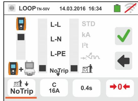
3. Spostare il riferimento della barra scorrevole selezionando il tipo di protezione (Fusibile di tipo **aM**, **gG**, magnetotermico MCB in curva **B**, **C**, **K**, **D** oppure la corrente nominale dell'RCD tra i valori **10**, **30**, **100**, **300**, **500**, **650**, **1000mA**). Per nazione AUS/NZ gli MCB disponibili sono solo **B**, **C**, **D**
