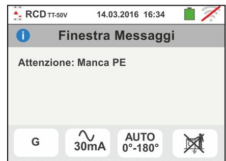
6. Qualora venga rilevato lo scambio tra i terminali di fase e neutro lo strumento non effettua la prova e visualizza una videata come quella a fianco. Ruotare la spina shuko o controllare il collegamento dei cavi di misura
