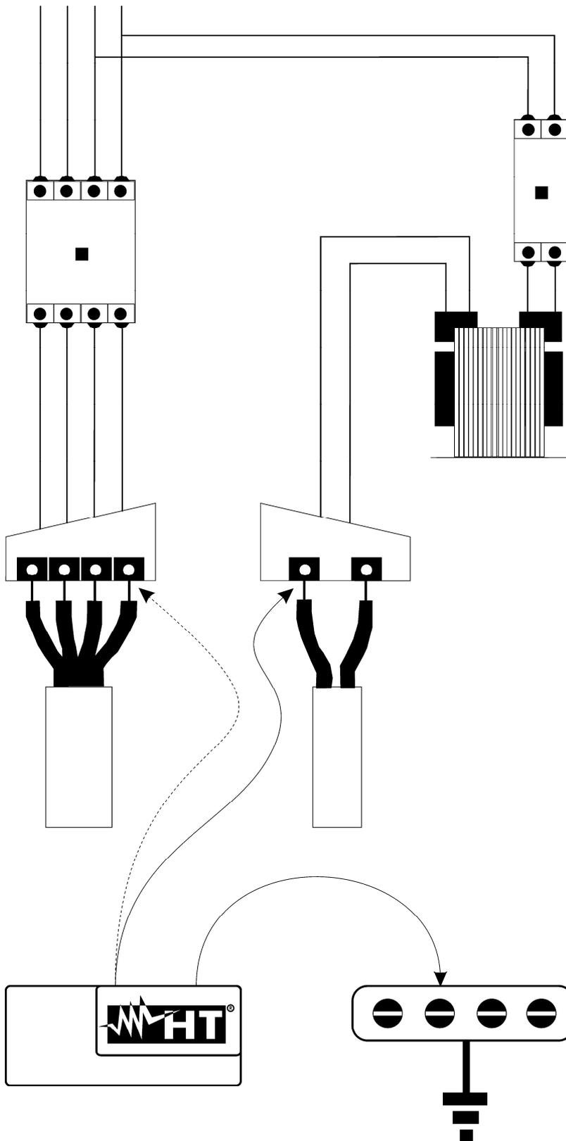
Trasformatore di isolamento o di sicurezza che effettua la separazione tra i circuiti
