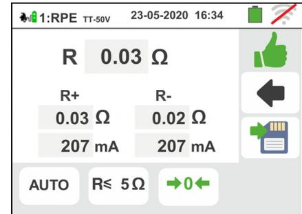
9. Al termine della prova nel caso in cui il valore della resistenza misurata risulti superiore al limite impostato la videata a fianco è mostrata a display. Il valore è mostrato in rosso e il simbolo
