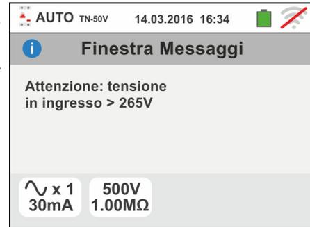
2. Qualora venga rilevata una tensione L-N o L-PE inferiore al limite minimo (100V) lo strumento non effettua la prova, visualizzando una videata come quella a fianco. Controllare che l'impianto in esame sia alimentato
