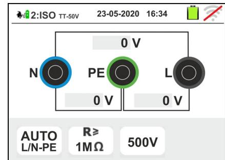
13 **Per sistemi EVSE Monofase** il risultato della misura è mostrato nella videata a fianco. I valori delle reali tensioni di prova sono presenti a display. Il simbolo indica il risultato ok della misura.
