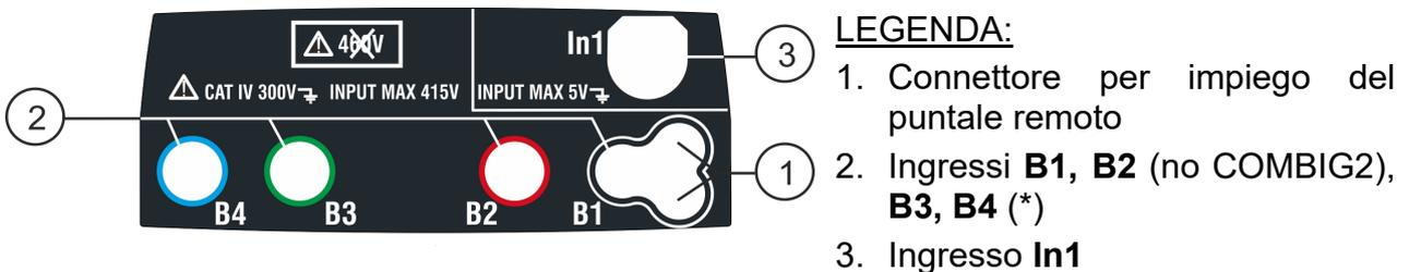
Fig. 2: Descrizione parte superiore dello strumento
