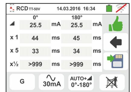
13 Al termine del test prova, nel caso in cui una prova non risulti in accordo a quanto elencato in Tabella 7 lo strumento visualizza il simbolo a segnalare l'esito negativo della prova e visualizza una videata come quella a fianco
