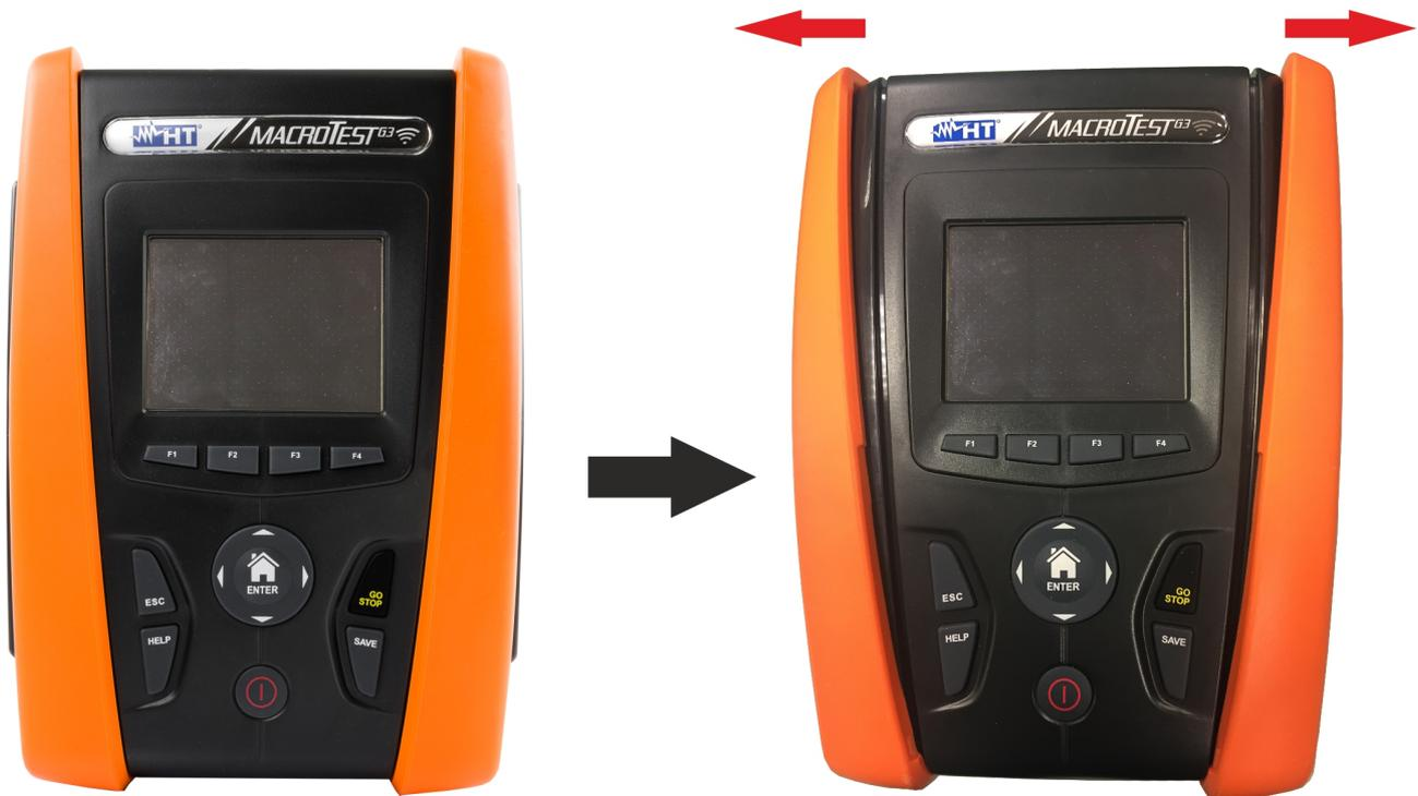
Fig. 40: Smontaggio semigusci laterali
