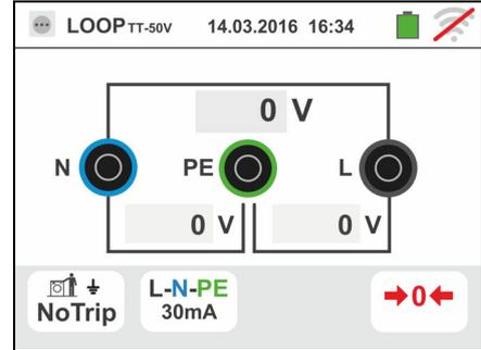
2. Spostare il riferimento della barra scorrevole sinistra selezionando l'icona per l'esecuzione della misura. Spostare il riferimento della barra scorrevole centrale selezionando l'opzione "NoTrip". Automaticamente il riferimento della barra scorrevole destra si imposta nella posizione . Confermare la scelta tornando alla videata iniziale della misura. Toccare l'icona in basso a destra. La seguente videata è mostrata a display
