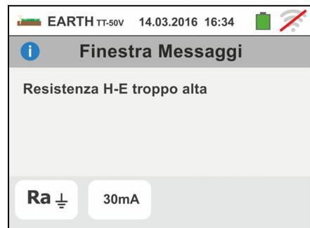
4. All'avvio della misurazione lo strumento verifica la situazione delle bocche B2 (S) e B3 (ES). In caso di inversione dei conduttori sull'impianto blocca la prova e mostra il messaggio visualizzato a lato
