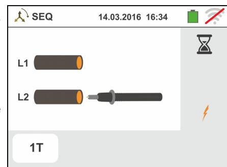
8. Al termine della prova, nel caso in cui il senso ciclico rilevato risulti corretto, lo strumento visualizza una videata come quella a fianco (risultato “1-2-3”)
