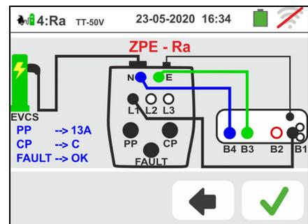
48 Il test è eseguito dallo strumento solo in modo "NoTrip " Fare riferimento al § 6.4.9 per la descrizione sull'impostazione dei parametri di prova relativamente alla corrente di intervento dell'RCD del sistema EVSE, assenza del conduttore di Neutro (sola misura possibile) e calibrazione preliminare dei terminali di misura.
