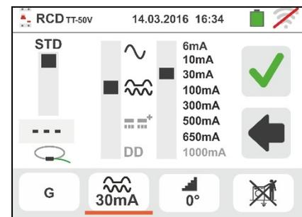
59 **Il modo Rampa ▲ è fisso sullo strumento.** Spostare il riferimento della barra scorrevole inferiore selezionando il tipo di visualizzazione della corrente di intervento durante la prova a Rampa tra le opzioni "NOM" o "REAL" (vedere § 6.3).
