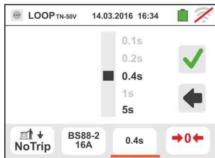
6. Scollegare, quando possibile, tutti i carichi connessi a valle del punto di misura in quanto l'impedenza dei suddetti utilizzatori potrebbe influenzare i risultati della prova. Eseguire la calibrazione preliminare dei terminali di misura come descritto nel § 0. Connettere la spina shuko, i coccodrilli od il puntale remoto alla rete elettrica in accordo alle Fig. 18, Fig. 19, Fig. 20 e Fig. 22 nel punto più lontano possibile dalla protezione in esame
