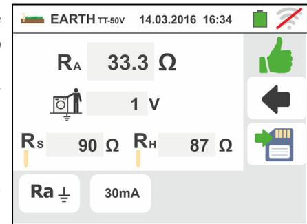
7. Per **misura di resistenza di terra nei sistemi TT** In caso di esito **negativo** (vedere § 13.7) la videata a fianco è mostrata dallo strumento in cui è presente il valore della tensione di contatto nel display secondario, il valore della resistenza di contatto della sonda di tensione ( $R_s$ ) e il valore della resistenza di contatto della sonda di corrente ( $R_h$ )
