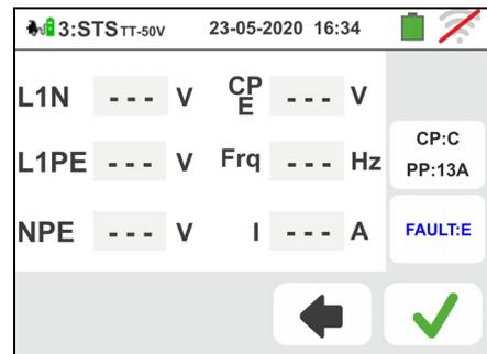
44 Il risultato delle misura è mostrato nella videata a fianco. Il simbolo indica il risultato ok della misura. Il simbolo indica anch'esso un risultato positivo della misura ma con valori esterni ai limiti presenti nella Tabella 4.
