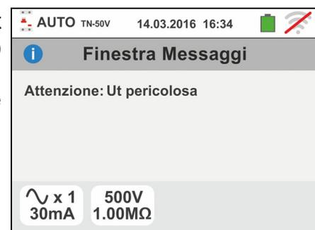
11 Qualora lo strumento rilevi ai propri terminali una tensione superiore a 10V non esegue la prova di isolamento L/N-PE, emette un segnale acustico prolungato e visualizza una videata come quella a fianco
