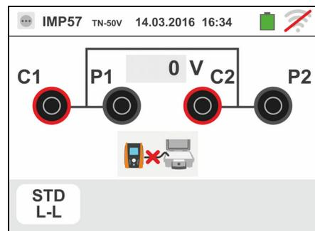
4. Il simbolo
