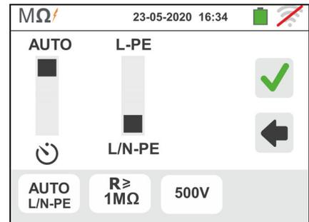
3. Toccare l'icona "R≥xxΩ" per impostare il valore limite minimo della resistenza di isolamento su cui lo strumento esegue la comparazione con il valore misurato. La videata a fianco è mostrata a display
