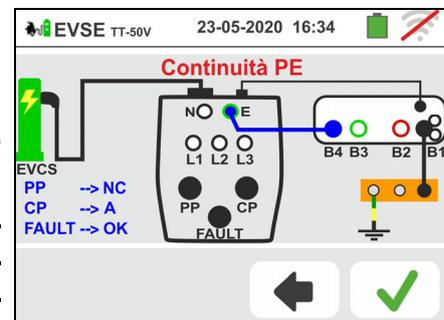
7. Il test RPE è eseguito dallo strumento **solo in modo AUTO**. Impostare il valore della soglia limite ed eseguire la calibrazione dei cavi di misura come mostrato nel § 6.1
