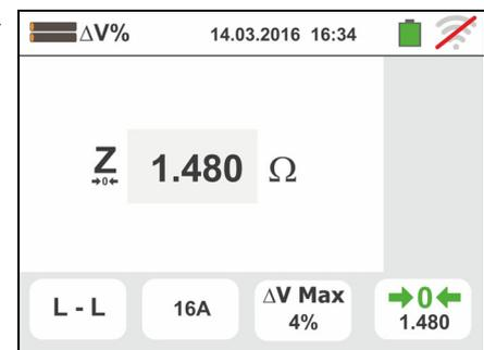
9. Collegare lo strumento nel punto finale della linea in esame in accordo alle Fig. 34 o Fig. 35 in modo da eseguire la misura di impedenza a fine linea **Z2**. La videata a fianco è mostrata a display. Notare la presenza a display del valore **Z1 (Offset)** precedentemente misurato
