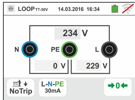
5. Premere il tasto **GO/STOP per alcuni secondi** oppure il tasto **START** sul puntale remoto. Durante tutta questa fase non scollegare i terminali di misura dello strumento dall'impianto in esame. In caso di esito positivo (resistenza globale di terra inferiore al rapporto tra tensione di contatto limite e corrente di intervento dell'RCD – vedere § 13.7) la videata a fianco è mostrata dallo strumento in cui è presente il valore della tensione di contatto nel display secondario
