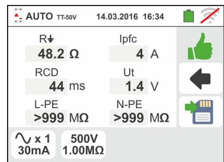
9. In caso di esito **positivo** delle tre prove eseguite in sequenza **NoTrip** (vedere § 13.8), **RCD** (vedere § 13.4) e **MΩ L/N-PE** lo strumento visualizza il simbolo e la videata a fianco è mostrata a display.
