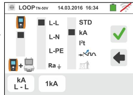
3. Toccare l'icona per azzerare il valore nel campo kA e usare la tastiera virtuale per impostare il valore del potere di interruzione della protezione compreso tra **1kA** e **9999kA**.
