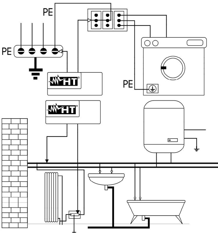
Collegare uno dei puntali al conduttore di protezione della presa forza motrice e l'altro al nodo equipotenziale dell'impianto di terra.
