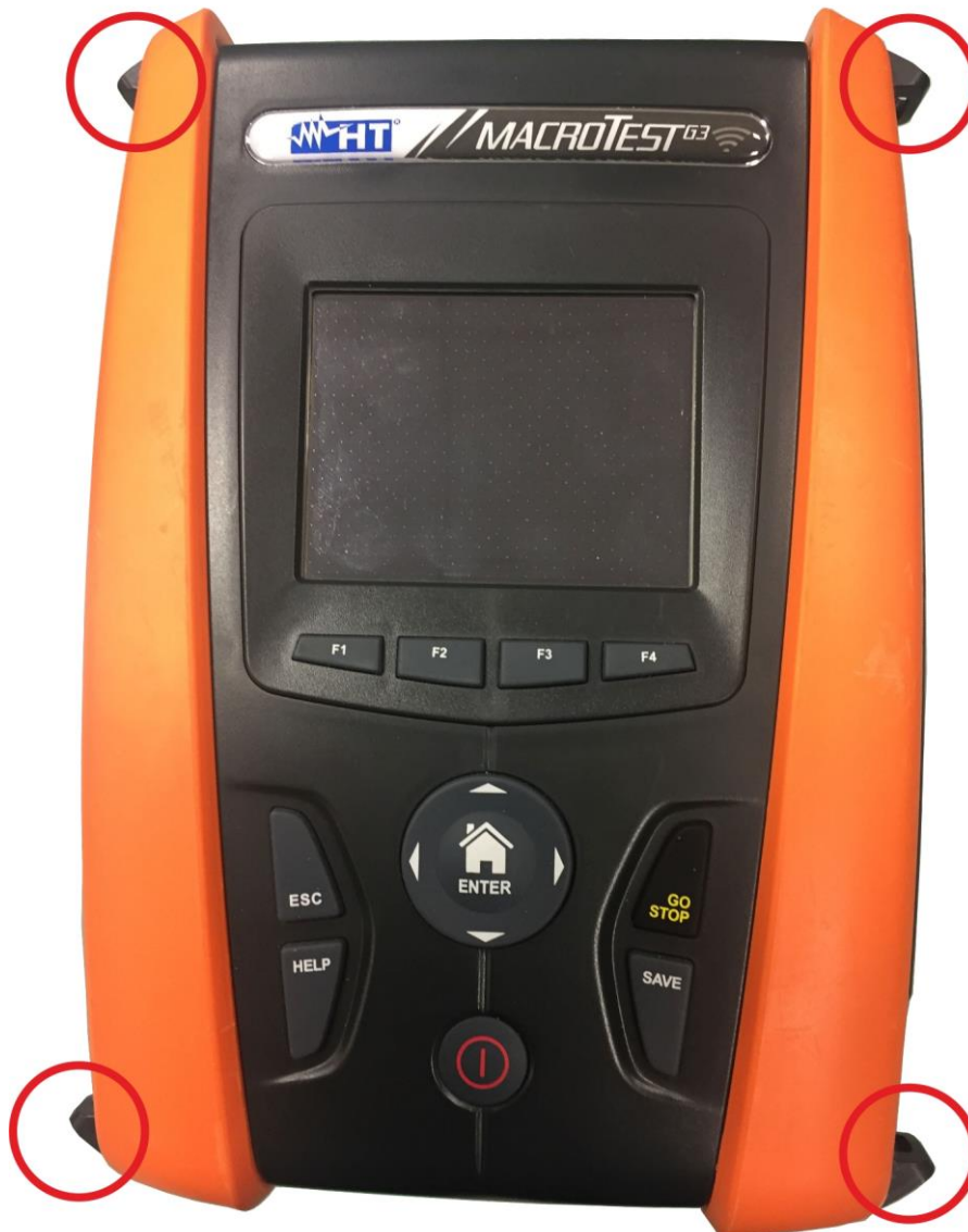
Fig. 42: Strumento con semigusci e ganci montati
