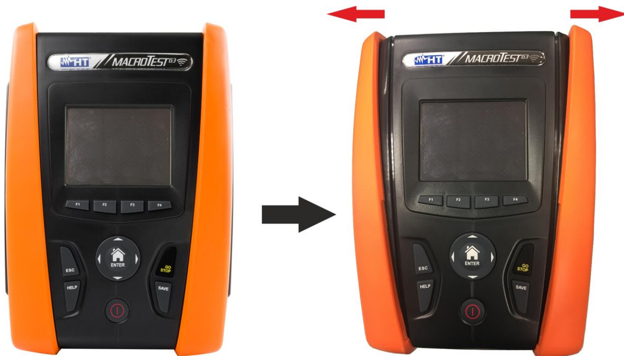
Fig. 40: Smontaggio semigusci laterali
