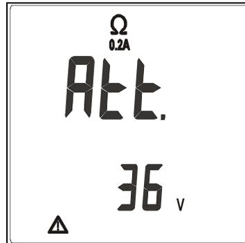
Valore della tensione rilevata in ingresso
