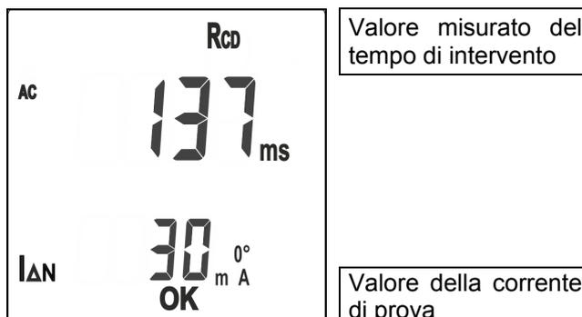
9. Al termine della prova, nel caso in cui il valore del tempo di intervento rilevato risulti **superiore a 300ms (40ms per  $I_{\Delta n}=30\text{mA} \times 5$ )**, oppure nel caso in cui l'interruttore differenziale non intervenga, lo strumento emette un segnale acustico prolungato che segnala l'esito negativo della prova e visualizza una videata come quella a fianco
