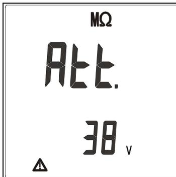
Valore della tensione rilevata in ingresso.
