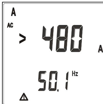
Esempio con fondo scala della pinza impostato a 400A AC
