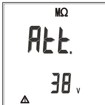
Valore della tensione rilevata in ingresso.
