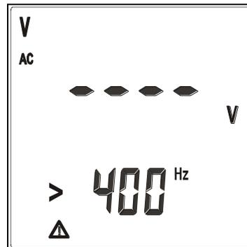
3. Qualora, effettuando una misurazione di frequenza, il valore misurato ecceda i **400Hz** lo strumento visualizza la videata accanto
