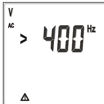
4. Qualora, effettuando una misurazione di frequenza, il valore misurato non raggiunga i **30.0Hz** lo strumento visualizza la videata accanto
