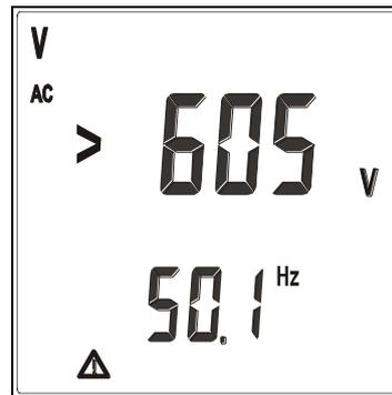
2. Qualora durante una misurazione di tensione il valore di frequenza misurato ecceda i **400Hz** lo strumento visualizza la videata accanto
