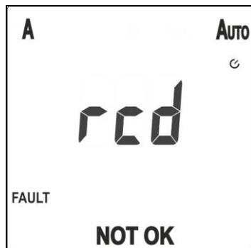
15. Durante la prova AUTO, nel caso in cui il test sulla misura di isolamento abbia dato esito negativo, lo strumento visualizza una videata come quella a fianco. Premere i tasti freccia per uscire dalla videata
