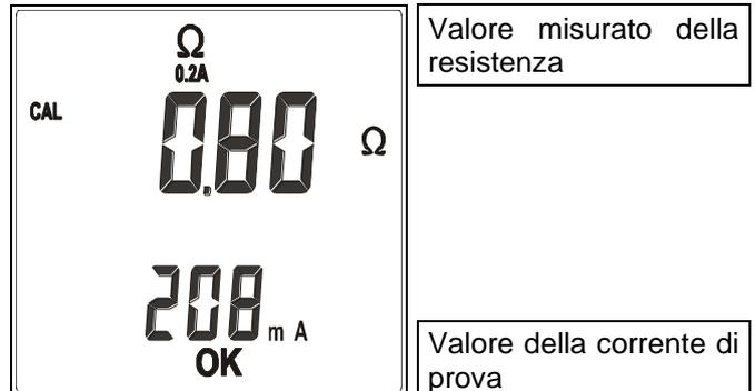
11. Al termine della prova, nel caso in cui non sia stato possibile generare 200mA a causa dell'elevato valore di resistenza, lo strumento emette un segnale acustico prolungato che segnala l'esito negativo della prova e visualizza una videata come quella a fianco
