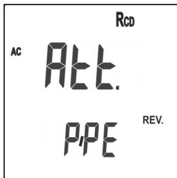
4. Qualora all'atto della misurazione sia rilevata una tensione di contatto troppo elevata tale da superarsi il limite normativo di 50V, lo strumento non effettua la prova. Viene emesso un segnale acustico prolungato a segnalare la situazione anomala e viene visualizzata la videata a fianco per 5 secondi trascorsi i quali lo strumento visualizza la videata di default relativa alla prova RCD
