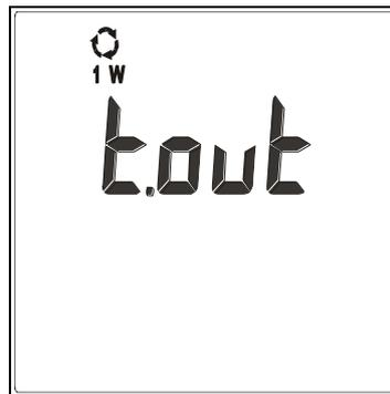
2. Qualora sia selezionata la modalità 1W e lo strumento rilevi la connessione del secondo puntale come in modalità 2W viene visualizzata la videata a fianco e viene emesso un segnale acustico prolungato fino a che la condizione di errore non venga rimossa
