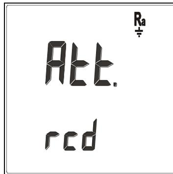
2. Qualora all'atto della misurazione sia rilevata una tensione in ingresso **superiore a 265V** (esempio: entrambi i cavi collegati a conduttori di fase di un impianto trifase 400V) lo strumento non effettua la prova. Viene emesso un segnale acustico prolungato a segnalare la situazione anomala e viene visualizzata la videata a fianco per 5 secondi trascorsi i quali lo strumento visualizza la videata di default relativa alla prova Ra  $\perp$
