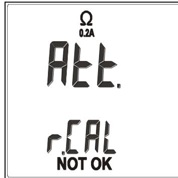
2. Se, all'atto della misura, la tensione presente ai terminali è  $>10V$ , lo strumento non effettua la prova. Viene emesso un segnale acustico prolungato a segnalare la situazione anomala e viene visualizzata la videata a fianco per 5s, trascorsi i quali lo strumento visualizza la videata di default relativa alla prova  $\Omega$  0.2A
