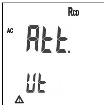
5. Con corrente nominale **30mA<sub>x5</sub>**, qualora all'atto della misurazione sia rilevata una resistenza di terra troppo elevata, tale da impedire allo strumento la generazione della corrente di prova, lo strumento non effettua la prova. Viene emesso un segnale acustico prolungato a segnalare la situazione anomala e viene visualizzata la videata a fianco per 5 secondi trascorsi i quali lo strumento visualizza la videata di default relativa alla prova RCD
