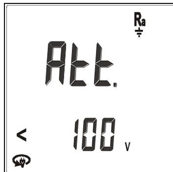
Questa condizione può verificarsi, a titolo di esempio, qualora il cavo nero venga collegato erroneamente al conduttore di neutro anziché al conduttore di fase. Se si utilizza il cavo shuko ruotare la spina e ripetere la prova
