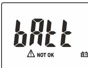
Fig. 45: Videata con indicazione batteria scarica
