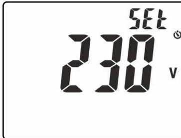
Fig. 6: Impostazione tensione nominale nelle misure di Loop
