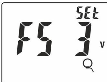
Fig. 7: Impostazione fondo scala pinza flessibile
