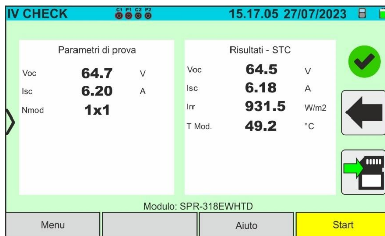
Fig. 67: Esempio di risultato positivo test IVCK – Valori STC
