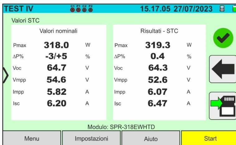
Fig. 43: Esempio di risultato misura curva I-V – Valori STC
