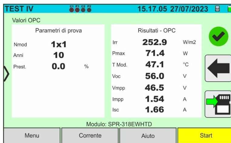
Fig. 44: Esempio di risultato misura curva I-V – Valori OPC
