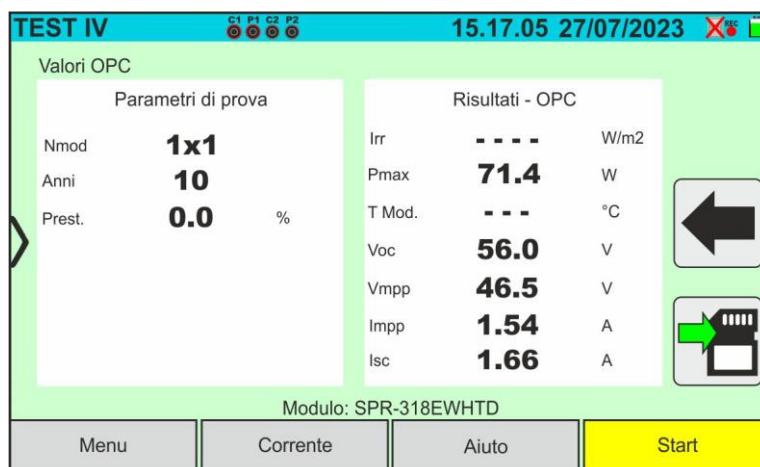
Fig. 54: Risultato misura curva I-V @OPC con registrazione sincrona
