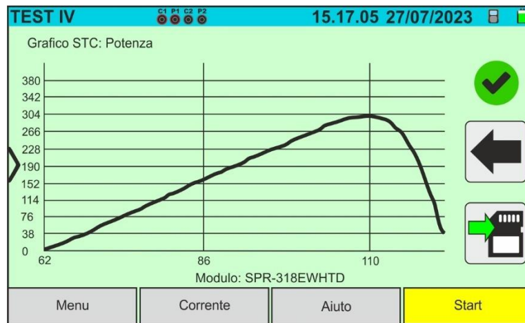
Fig. 46: Esempio di risultato misura Potenza – Curva STC
