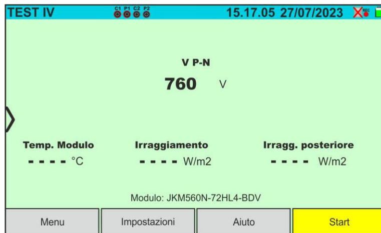
Fig. 52: Videata curva I-V con SOLAR03 in registrazione sincrona su moduli Bifacciali
