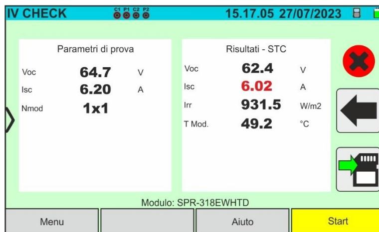
Fig. 68: Esempio di risultato negativo test IVCK – Valori STC
