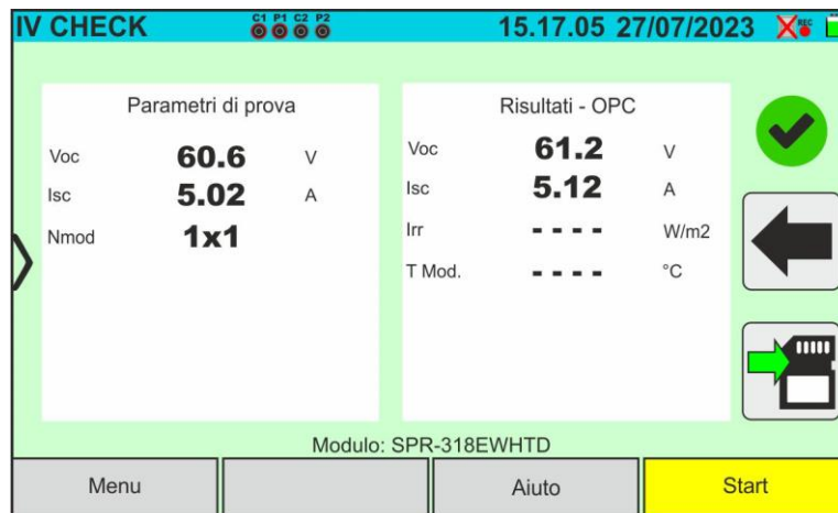
Fig. 76: Risultato misura test IVCK @OPC con registrazione sincrona
