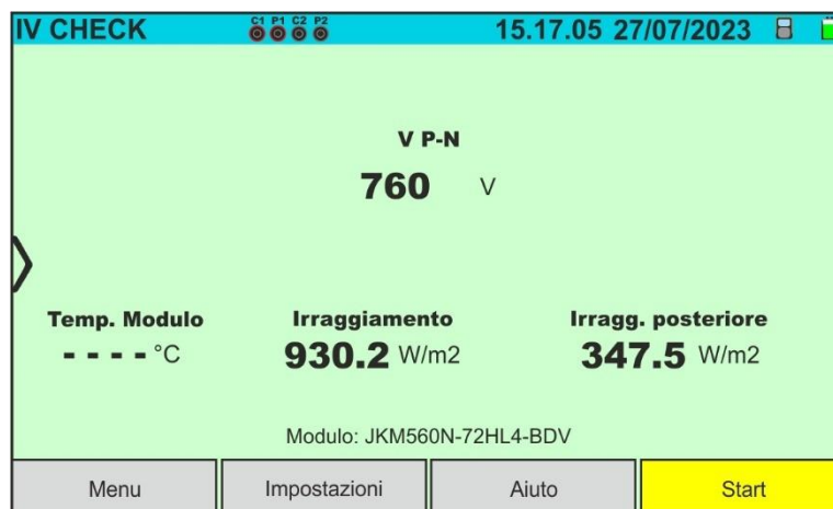
Fig. 65: Videata iniziale test IVCK senza unità remota su moduli Bifacciali
