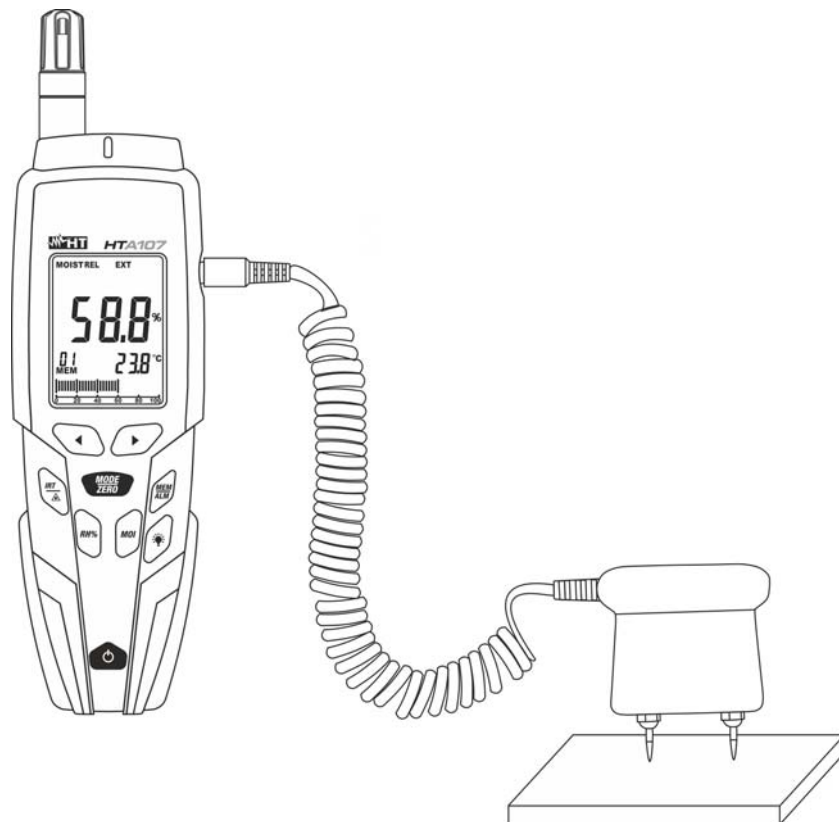
Fig. 9: Uso dello strumento per misura dell'umidità a contatto con sonda esterna
