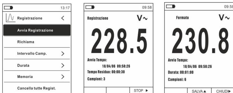
**Fig.37:** Data logger – Avvio e terminazione registrazione
