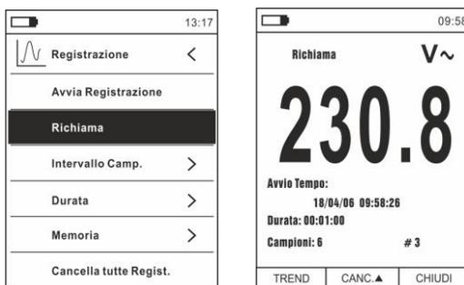
**Fig. 38:** Data logger – Richiamo a display dati registrazione
