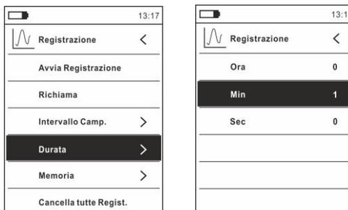
**Fig.36:** Data logger – Impostazione durata registrazione
