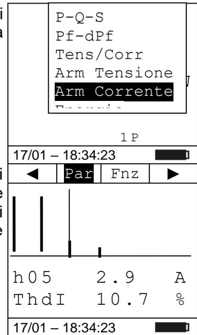
14. Nella videata a lato un esempio di misura di Armoniche di Corrente. Premendo i tasti **F1 (◀)** o **F4 (▶)** è possibile spostare il cursore sul grafico e selezionare l'armonica che si desidera misurare. E' possibile misurare fino al 25° ordine con visualizzazione del parametro THDI% (vedere § 10.1)
