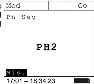
9. Se le due fasi alle quali è stato collegato il puntale sono nella corretta sequenza, lo strumento visualizza il messaggio "**123**". Se le due fasi alle quali è stato collegato il puntale NON sono nella corretta sequenza, lo strumento visualizza il messaggio "**132**".
