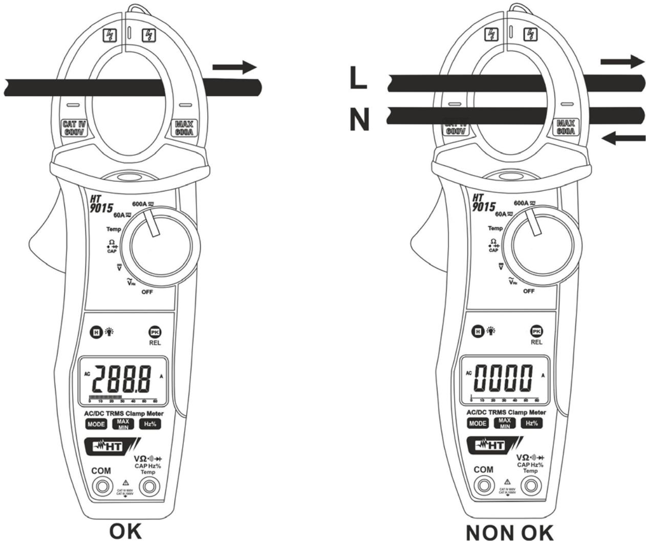
Fig. 9: Uso della pinza per misure di corrente DC
