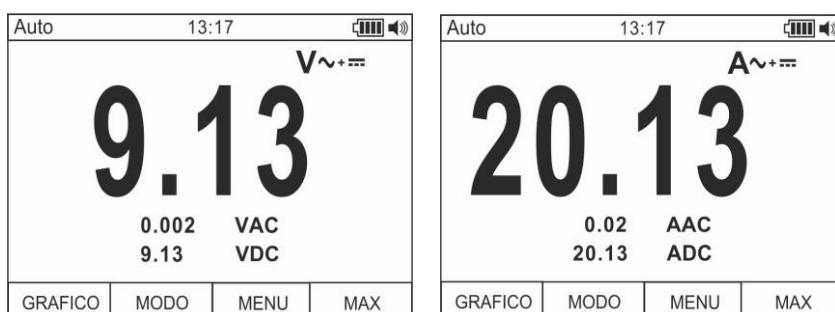
Fig. 3: Descrizione misura tensione e corrente AC+DC
