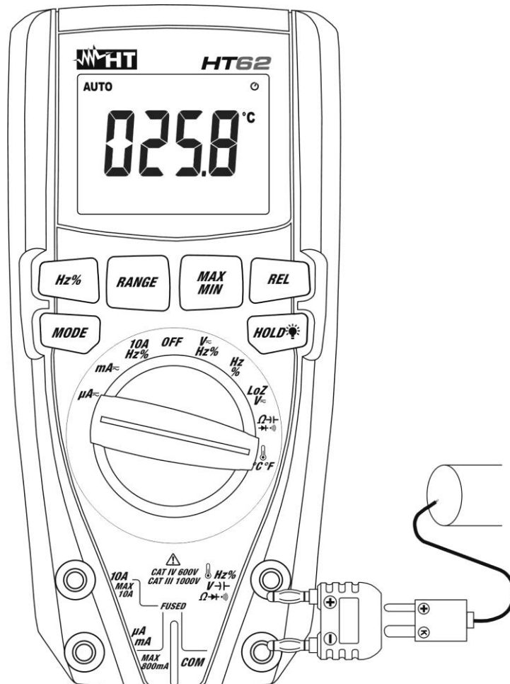
Fig. 9: Uso dello strumento per misura di Temperatura
