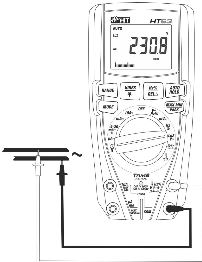
Fig. 4: Uso dello strumento per misura di Tensione AC/DC con funzione LoZ
