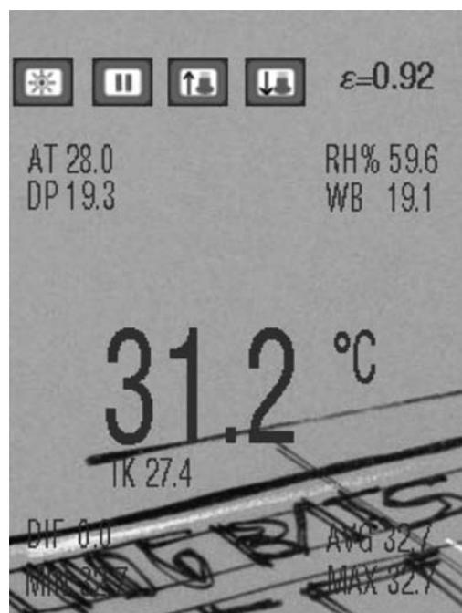
Fig. 7: Esecuzione misura di temperatura IR con fotocamera integrata
