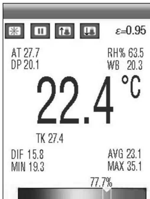
Fig. 11: Esecuzione misura di temperatura punto di rugiada
