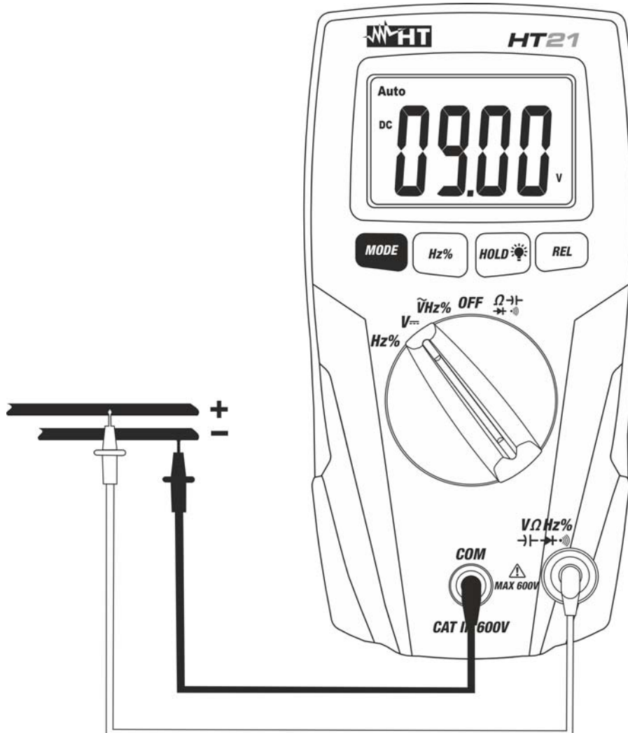
Fig. 2: Uso dello strumento per misura di Tensione DC
