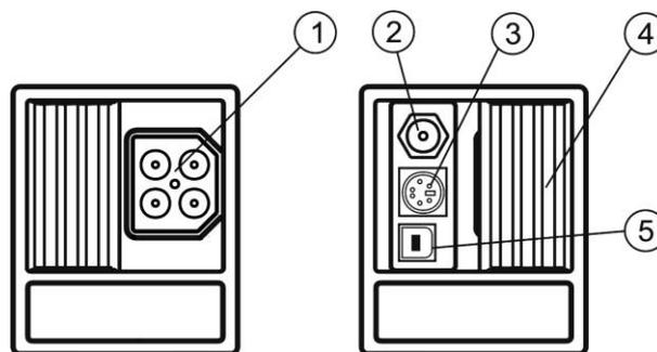
Fig. 3: Descrizione parte superiore dello strumento HT2055M
