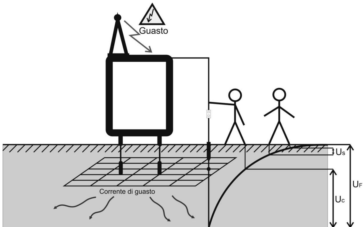
Fig. 16: Tensioni pericolose durante una condizione di guasto
