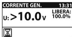
La tensione tra i terminali di prova C1/H e C2/E durante la generazione di corrente è maggiore del valore limite ammesso (10V). Scollegare i terminali e controllare questa condizione
