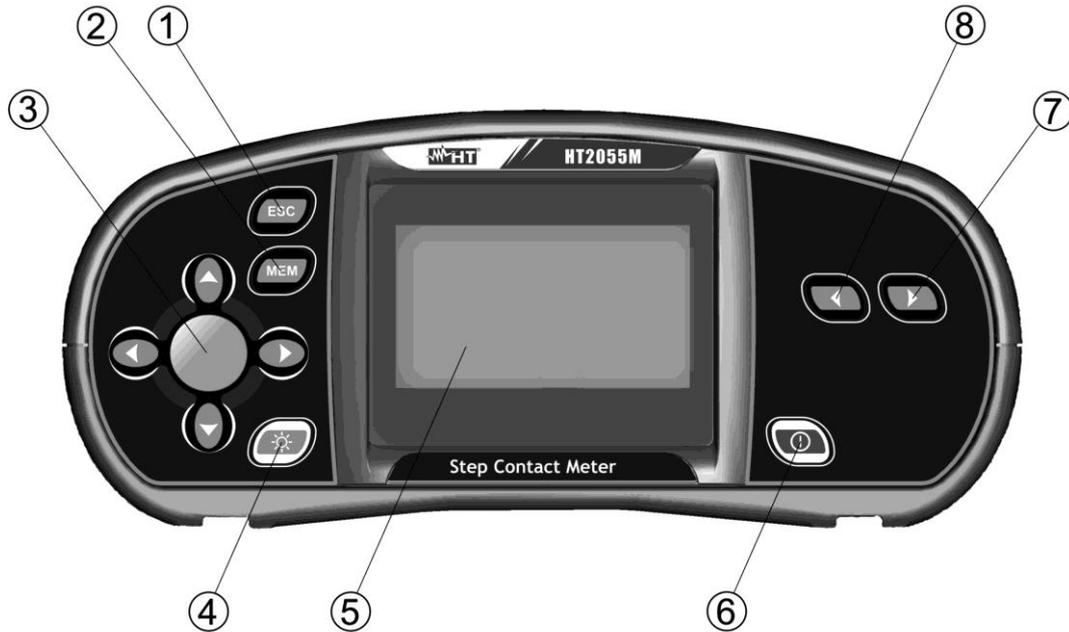
Fig. 2: Descrizione parte frontale dello strumento HT2055M
