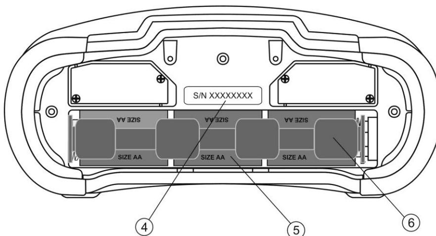
Fig. 5: Descrizione vano batterie dello strumento HT2055M
