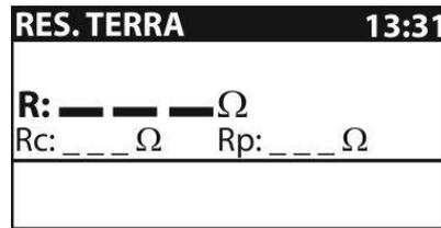
Fig. 25: Videata iniziale misura resistenza di terra
