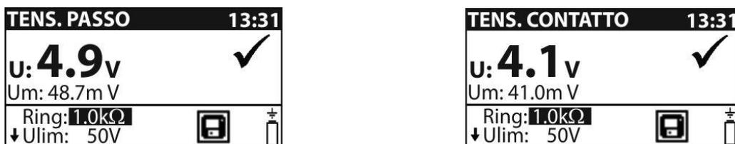
Fig. 22: Videate per risultato misura di tensione di passo e contatto
