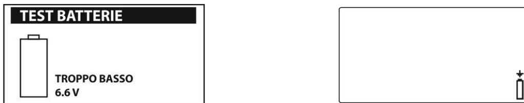
Fig. 39: Condizione di batterie scariche e ricarica batterie
