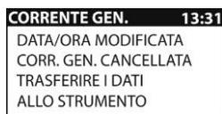
La data/ora è stata modificata nell'unità di potenza e la sincronizzazione tra le unità è persa. Il valore della corrente di prova deve essere cancellato prima di procedere con le misure. Prima dell'azzeramento i dati possono essere scaricati
