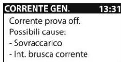
Durante la generazione di corrente una condizione di sovracorrente esterna o una interruzione del circuito è intervenuta. In tal caso è raccomandato diminuire la potenza in uscita (vedere § 6.1.2)
