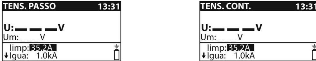
Fig. 21: Videate per misura di tensione di passo e contatto
