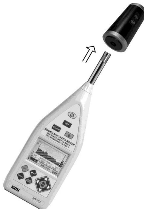
Fig. 36: Inserimento del calibratore HT151 sullo strumento
