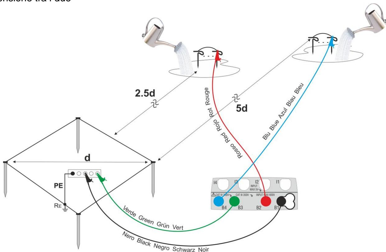
Fig. 53: Misura di terra per reti di terra di piccole dimensioni
