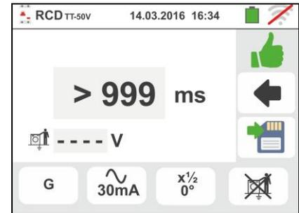
11 Al termine della prova, **per RCD tipo scatolato STD** nel caso in cui il tempo di intervento una prova non risulti in accordo a quanto elencato in Tabella 5
