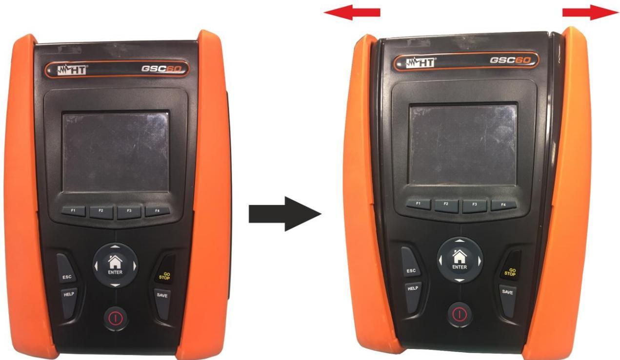
Fig. 46: Smontaggio semigusci laterali
