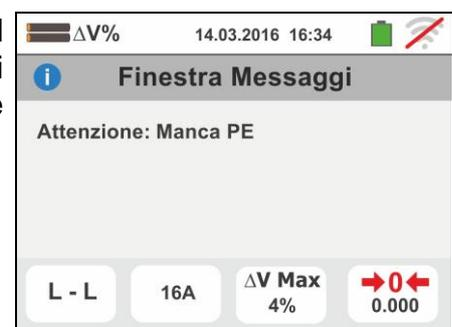
6. Qualora venga rilevato lo scambio tra i terminali di fase e neutro lo strumento non effettua la prova e visualizza una videata come quella a fianco. Ruotare la spina shuko o controllare il collegamento dei cavi di misura
