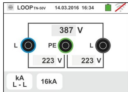
5. Premere il tasto **GO/STOP** per 2s oppure il tasto **START** sul puntale remoto. Durante tutta questa fase non scollegare i terminali di misura dello strumento dall'impianto in esame.
