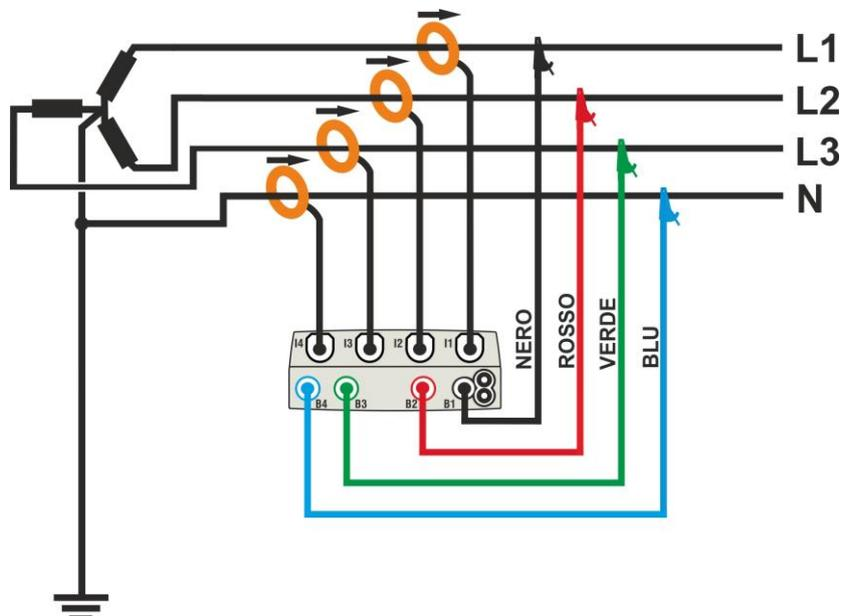
Fig. 37: Collegamento per misura su impianto Trifase 3φ-4FILI
