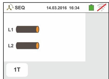
2. Spostare il riferimento della barra scorrevole nella posizione “1T” per la selezione del test a 1 terminale oppure nella posizione “2T” per la selezione del test a 2 terminali
