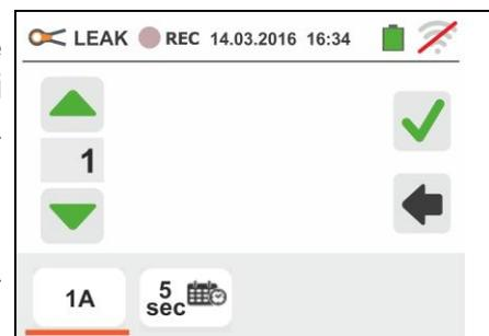
3. Spostare il riferimento della barra scorrevole di sinistra per selezionare il periodo di integrazione (vedere §) tra le opzioni: **2s, 5s, 10s, 30s, 1min, 2min, 5min, 10min, 15min, 30min**
