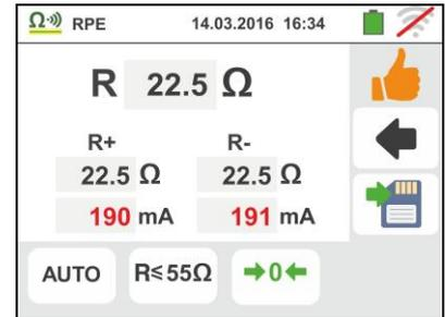
2. Qualora in modo lo strumento rilevi ai propri terminali una resistenza superiore a 2Ω azzera il valore compensato e visualizza una videata come quella a fianco. L'icona è mostrata a display ad indicare il valore azzerato della calibrazione (es: eseguendo l'operazione con terminali aperti)
