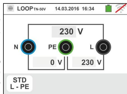
6. Il valore della corrente di cortocircuito presunta ( $I_{sc}$ ) è mostrato nella parte superiore del display mentre il valore dell'impedenza di Loop (L-L, L-N o L-PE) è presente nella parte inferiore del display.
