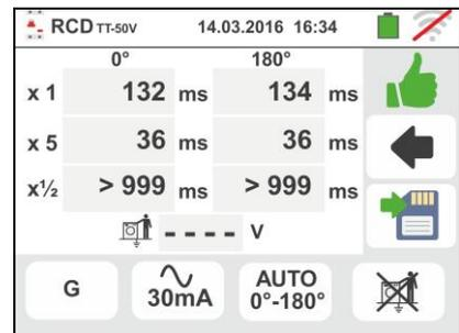
13 Al termine della prova, nel caso in cui il tempo di intervento una prova non risulti in accordo a quanto elencato in Tabella 5 lo strumento visualizza il simbolo
