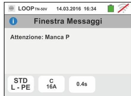
4. Se lo strumento rileva l'assenza del segnale sul terminale B4 (conduttore di neutro) fornisce la videata di avviso mostrata a lato e blocca lo svolgimento delle prove
