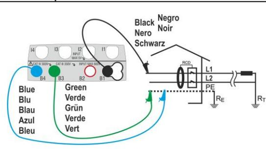
Fig. 11: Collegamento in sistema bifase senza neutro (no RCD tipo B/B+)
