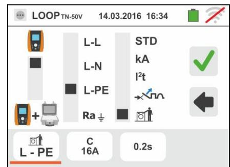
3. Spostare il riferimento della barra scorrevole selezionando il tipo di protezione (Fusibile di tipo **gG** o **aM** o magnetotermico MCB in curva **B, C, K, D**)
