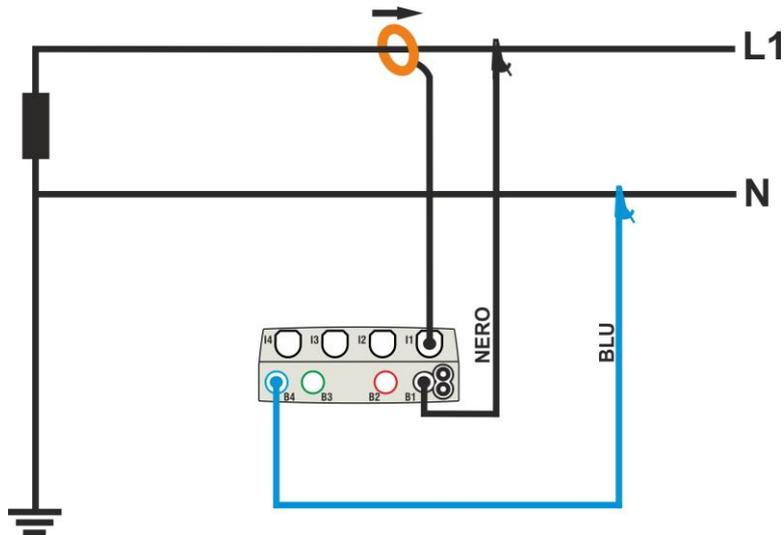
Fig. 36: Collegamento per misura su impianto Monofase 1φ-2FILI
