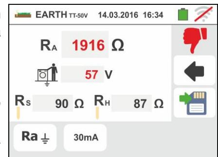
8. Per **misura di resistenza di terra nei sistemi IT** In caso di esito **negativo** (vedere § 13.8) la videata a fianco è mostrata dallo strumento in cui è presente il valore della tensione di contatto nel display secondario, il valore della resistenza di contatto della sonda di tensione ( $R_s$ ) e il valore della resistenza di contatto della sonda di corrente ( $R_h$ )
