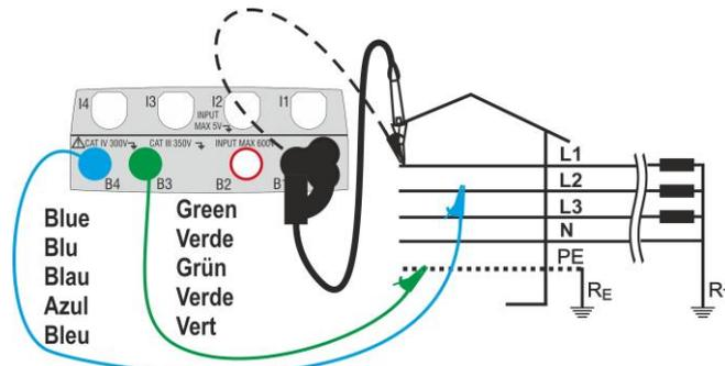
Fig. 20: Misura L-L in impianti trifase con cavi singoli e puntale remoto
