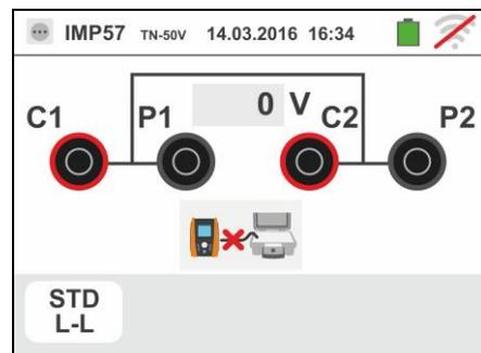
4. Il simbolo
