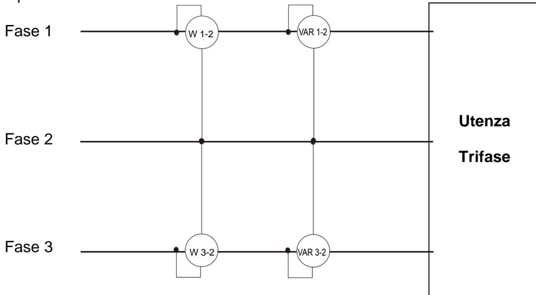
In questo caso si assume come potenziale di riferimento il potenziale di uno delle tre fasi (ad esempio la fase 2) e si esprimono i valori della potenza attiva, reattiva e apparente totali come somma delle indicazioni delle coppie di wattmetri, VARmetri e VAmetri.
