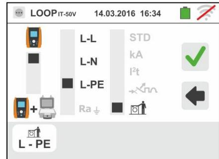
3. Scollegare, quando possibile, tutti i carichi connessi a valle del punto di misura in quanto l'impedenza dei suddetti utilizzatori potrebbe influenzare i risultati della prova. Connettere coccodrilli o il puntale remoto alla rete elettrica in accordo alla Fig. 22
