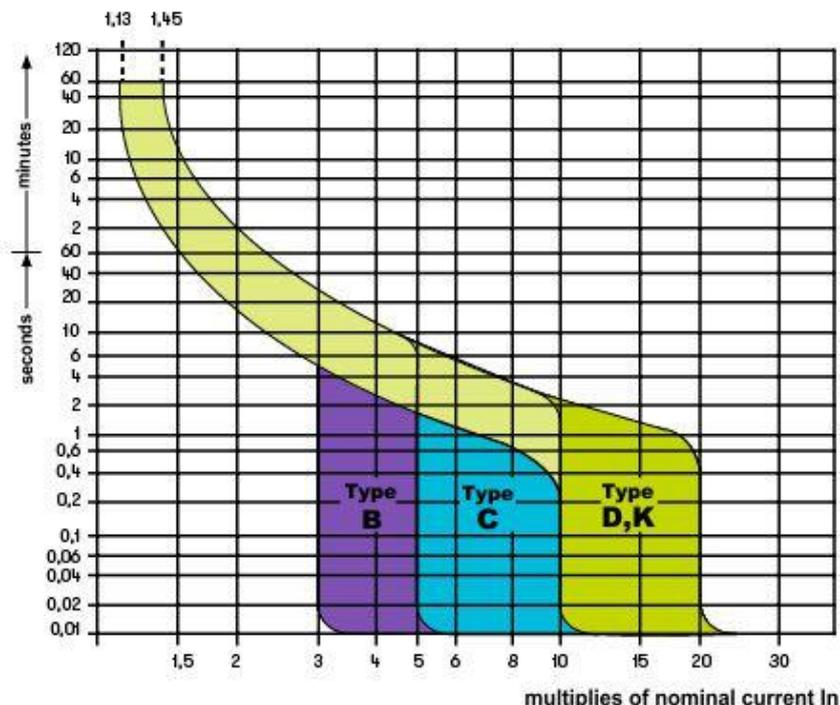
Fig. 52: Esempio di curve di intervento protezioni magnetotermiche (MCB)
