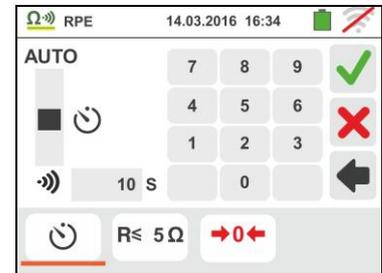
4. Toccare l'icona "R≤xxΩ" per impostare il valore limite massimo della resistenza su cui lo strumento esegue la comparazione con il valore misurato. La videata a fianco è mostrata a display
