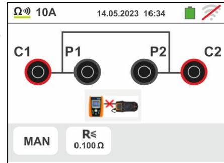
2. Collegare l'accessorio **EQUITEST** all'alimentazione principale di rete e notare l'accensione del LED verde POWER. Collegare l'accessorio allo strumento tramite il cavo **C2050**. La videata a fianco è mostrata a display con accessorio collegato regolarmente.
