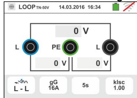
2. Spostare il riferimento della barra scorrevole sinistra selezionando l'icona per l'esecuzione della misura con il solo strumento oppure l'icona per l'esecuzione della misura con strumento + accessorio opzionale IMP57 (vedere § 6.4.10).
