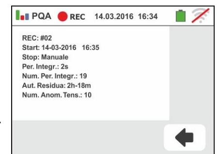
16 Premere il tasto **GO/STOP** per terminare la registrazione che lo strumento salva **automaticamente in memoria**. Il messaggio a fianco è mostrato a display.
