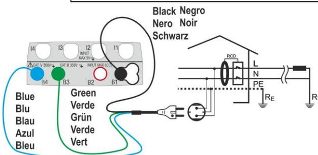
Fig. 10: Collegamento in sistema monofase tramite spina shuko
