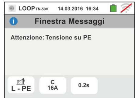
9. Qualora venga rilevata la presenza di una tensione VN-PE >50V (oppure > 25V in base alla selezione) lo strumento non effettua la prova e visualizza una videata come quella a fianco
