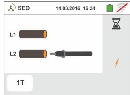
8. Al termine della prova, nel caso in cui il senso ciclico rilevato risulti corretto, lo strumento e visualizza una videata come quella a fianco (risultato "1-2-3")
