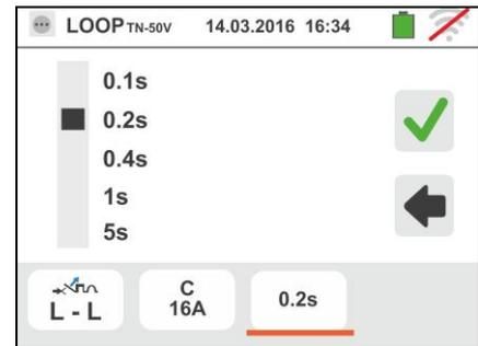
6. Scollegare, quando possibile, tutti i carichi connessi a valle del punto di misura in quanto l'impedenza dei suddetti utilizzatori potrebbe influenzare i risultati della prova. Connettere la spina shuko, i coccodrilli od il puntale remoto alla rete elettrica in accordo alle Fig. 17, Fig. 18, Fig. 19 e Fig. 21 nel punto più lontano possibile dalla protezione in esame
