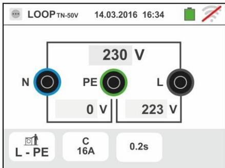
7. Premere il tasto **GO/STOP** per 2s oppure il tasto **START** sul puntale remoto. Durante tutta questa fase non scollegare i terminali di misura dello strumento dall'impianto in esame.
