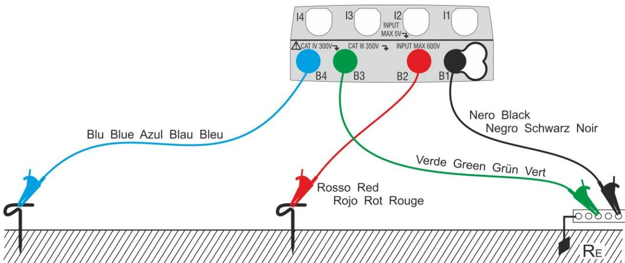
Fig. 27: Misura della resistenza di terra a 3 fili
