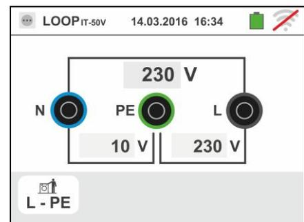
4. Premere il tasto **GO/STOP** per 2s oppure il tasto **START** sul puntale remoto. Durante tutta questa fase non scollegare i terminali di misura dello strumento dall'impianto in esame.
