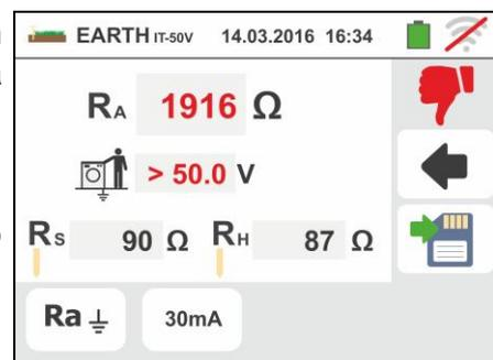
9. Per **misura di resistenza di terra nei sistemi TN** In caso di esito **positivo** (valore misurato **MINORE** del valore limite impostato) la videata a fianco è mostrata dallo strumento oltre al valore della resistenza di contatto della sonda di tensione ( $R_s$ ) e il valore della resistenza di contatto della sonda di corrente ( $R_h$ )
