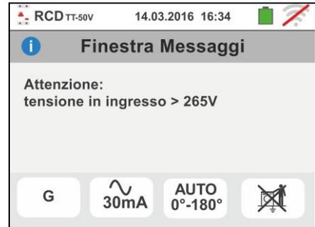
2. Se la tensione tra gli ingressi B1 e B4 e gli ingressi B1 e B3 è inferiore a 100V lo strumento fornisce la videata di avviso mostrata a lato e blocca lo svolgimento delle prove
