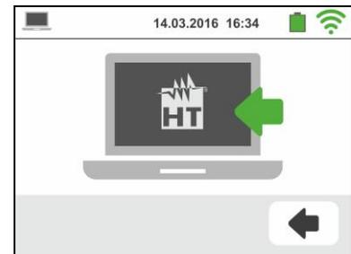
2. Abilitare la connessione WiFi sul PC di destinazione (ex: tramite uso di una chiavetta WiFi installata e collegata ad una porta USB) e connettersi alla rete WiFi resa disponibile dallo strumento (nome rete "GSC60\_XXXXXX" in cui XXXXXX è il numero di serie dello strumento)
