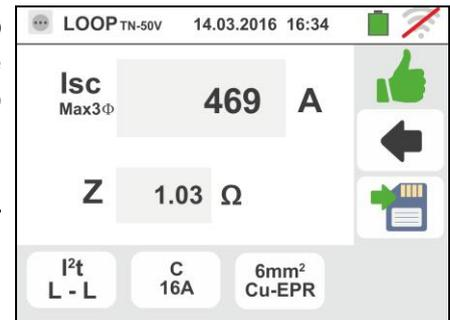
8. In caso di esito negativo della prova (corrente I<sub>sc</sub> trifase misurata nel caso L-L di figura NON sopportata dal cavo con le selezioni eseguite) la videata a fianco è mostrata dallo strumento
