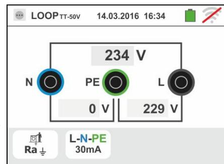
5. Premere il tasto **GO/STOP** per 2s oppure il tasto **START** sul puntale remoto. Durante tutta questa fase non scollegare i terminali di misura dello strumento dall'impianto in esame.
