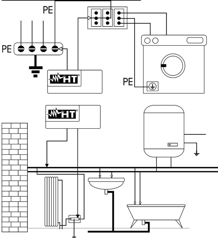
Collegare uno dei puntali al conduttore di protezione della presa forza motrice e l'altro al nodo equipotenziale dell'impianto di terra.
