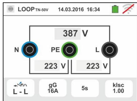
8. Premere il tasto **GO/STOP** per 2s oppure il tasto **START** sul puntale remoto. Durante tutta questa fase non scollegare i terminali di misura dello strumento dall'impianto in esame.
