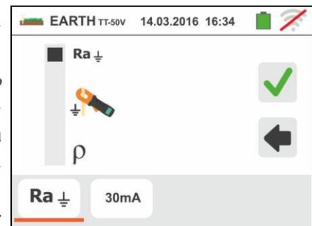
3. Spostare il riferimento della barra scorrevole nella posizione corrispondente al valore della corrente di intervento del differenziale RCD come mostrato nella videata a fianco. Sulla base di questa selezione e del valore della tensione di contatto (25V o 50V) lo strumento esegue il calcolo del valore limite della resistenza di terra (vedere § 13.7) che confronterà con il valore misurato al fine di fornire il risultato finale positivo o negativo della misura
