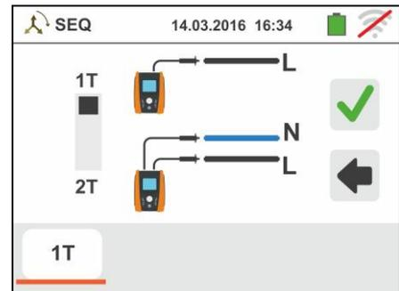
3. Inserire i connettori blu e nero dei cavi singoli nei corrispondenti terminali di ingresso dello strumento B4, B1 (misura 2T). Inserire all'estremità dei cavi rimasta libera i corrispondenti coccodrilli o puntali. Eventualmente utilizzare il puntale remoto inserendone il connettore multipolare nel terminale di ingresso B1. Connettere i coccodrilli, puntali o il puntale remoto alla fase L1 e N in accordo alle Fig. 23 e Fig. 24
