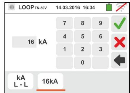
4. Scollegare, quando possibile, tutti i carichi connessi a valle del punto di misura in quanto l'impedenza dei suddetti utilizzatori potrebbe influenzare i risultati della prova. Connettere la spina shuko, i coccodrilli od il puntale remoto alla rete elettrica in accordo alle Fig. 17, Fig. 18, Fig. 19 e Fig. 21 nel punto più vicino possibile alla protezione in esame
