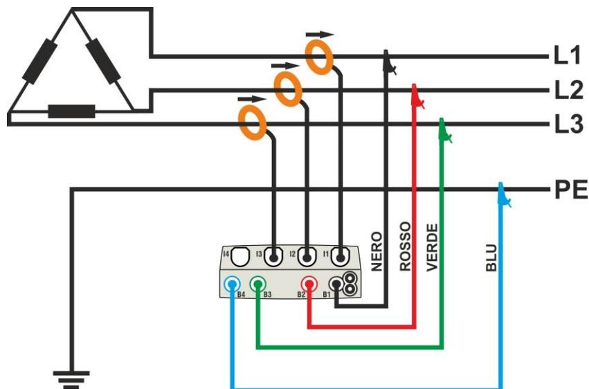
Fig. 38: Collegamento per misura su impianto Trifase 3φ-3FILI
