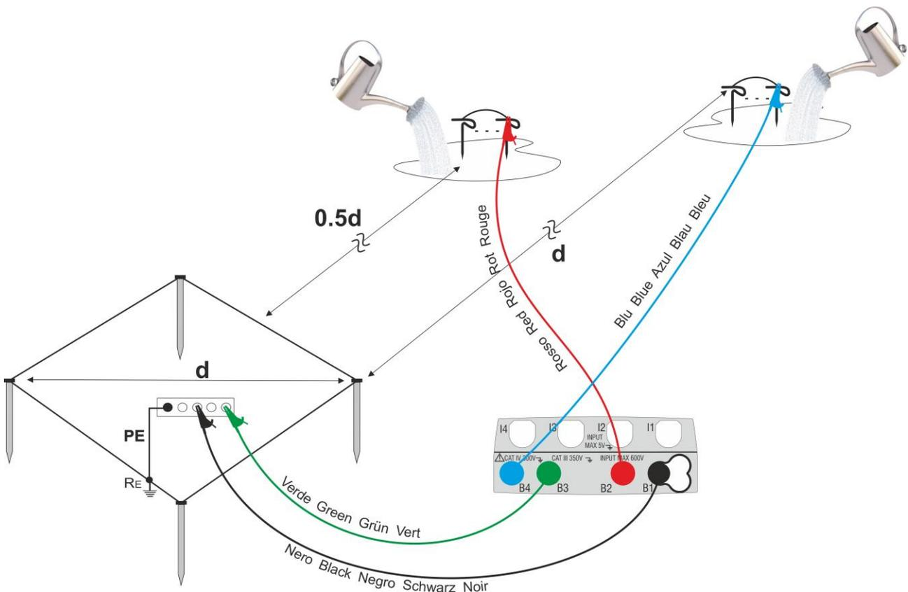
Fig. 54: Misura di terra per reti di terra di grandi dimensioni
