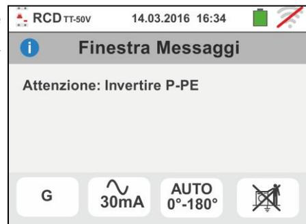
8. Qualora l'interruttore differenziale in esame intervenga durante la fase di pre-prova (eseguita in modo automatico dallo strumento prima di effettuare la prova selezionata), lo strumento non esegue il test e visualizza una videata come quella a fianco. Controllare che il valore impostato di  $I_{dN}$  sia coerente con l'interruttore differenziale in esame e che tutti i carichi connessi a valle dello stesso siano scollegati
