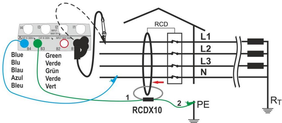
Fig. 16: Collegamento a RCD con toroide separato con accessorio opzionale RCDX10
