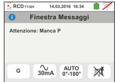
4. Se lo strumento rileva l'assenza del segnale sul terminale B4 (conduttore di neutro) fornisce la videata di avviso mostrata a lato e blocca lo svolgimento delle prove
