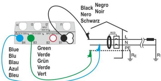
Fig. 12: Collegamento in sistema monofase con cavi singoli e puntale remoto
