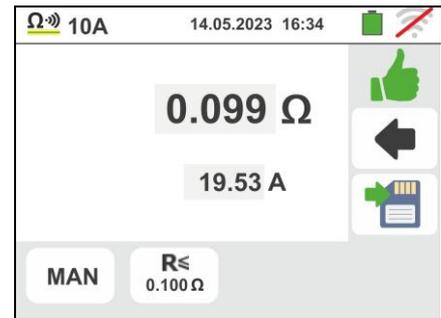
7. Al termine della prova, nel caso in cui il valore della resistenza misurata risulti superiore al limite impostato, la videata a fianco è mostrata a display
