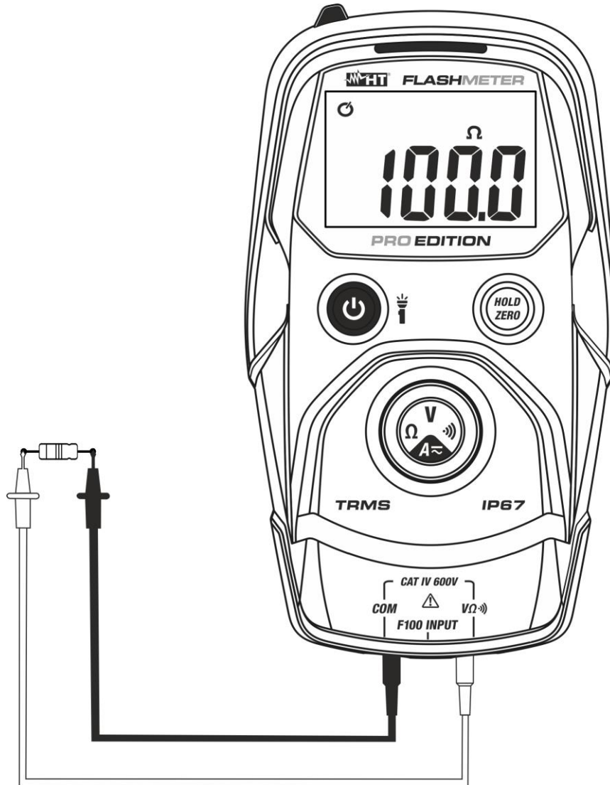
Abb. 5: Verwendung des Gerätes für Widerstandsmessung
