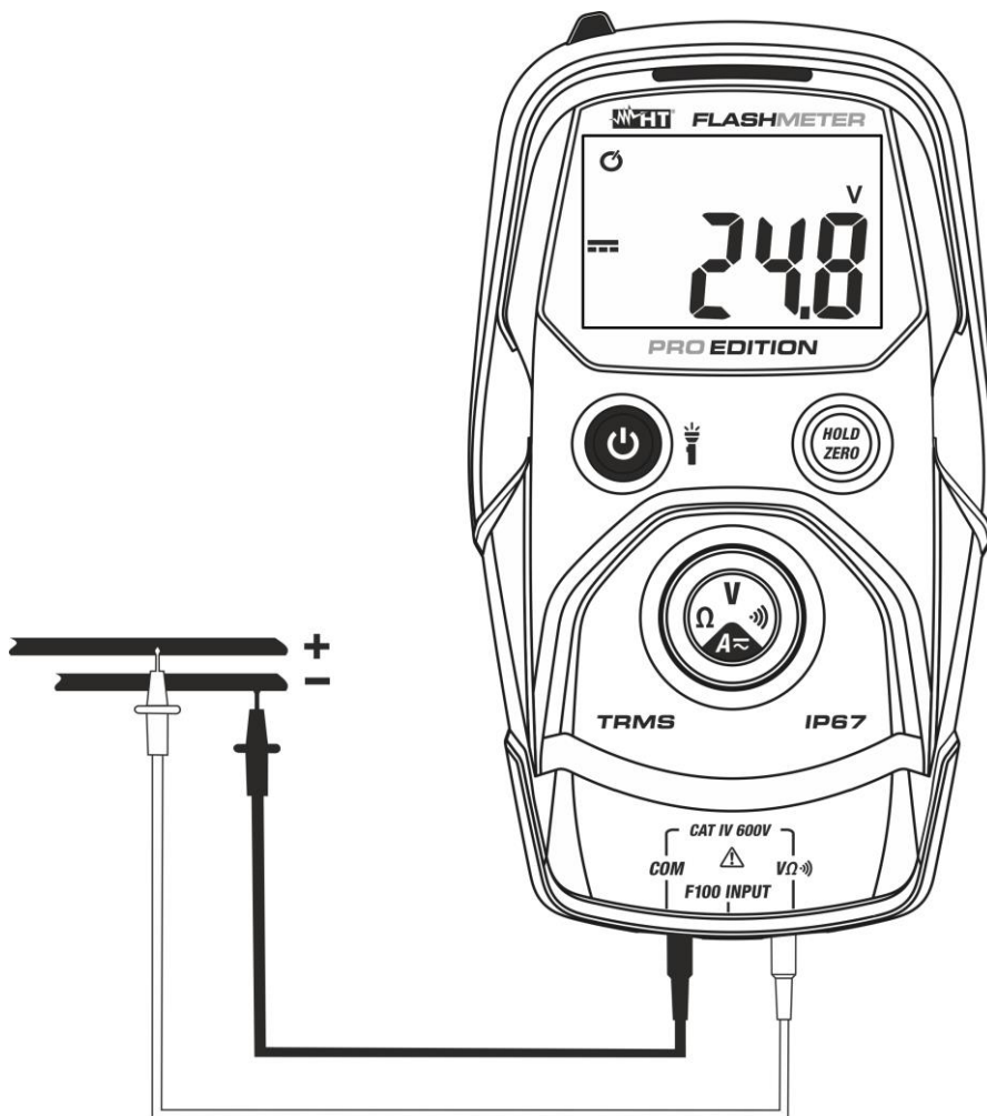
Fig. 3: Uso do instrumento para a medição de Tensões CC
