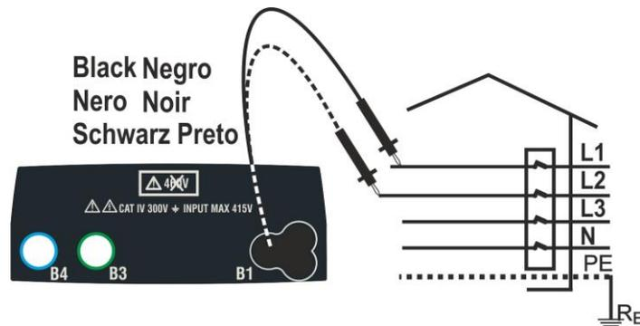
Fig. 35: Controllo sequenza fasi con cavo di misura
