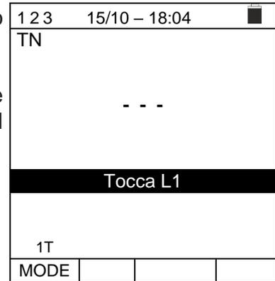
4. Premere il tasto **GO/STOP** sullo strumento o il tasto **START** sul puntale remoto. Lo strumento inizia il test
