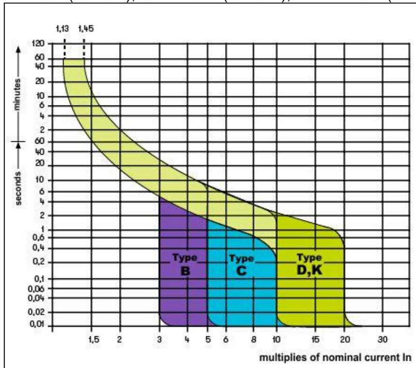
Fig. 41: Curve di intervento protezioni magnetotermiche (MCB)
