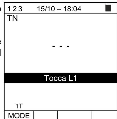
5. Lo strumento emette un suono lungo fino a quando non è presente la tensione di ingresso. Al termine dell'acquisizione della fase L1, lo strumento è in attesa del segnale sulla fase L2 e mostra il simbolo di "**Rilascia L1**" come mostrato nella videata a lato
