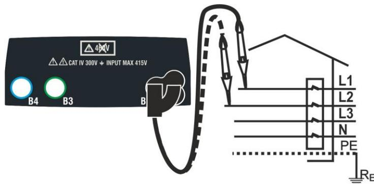
Fig. 36: Controllo sequenza fasi con puntale remoto
