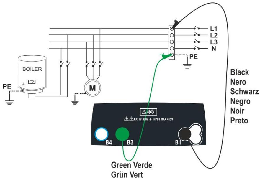
Fig. 17: Isolamento tra L-PE tramite cavi singoli (modo TMR)
