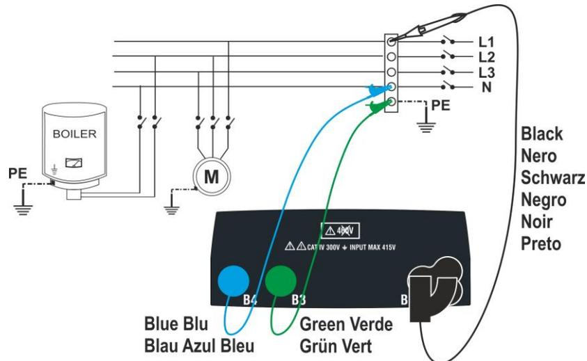
Fig. 14: Isolamento tra L-N-PE tramite cavi singoli e puntale remoto (modi MAN e AUTO)
