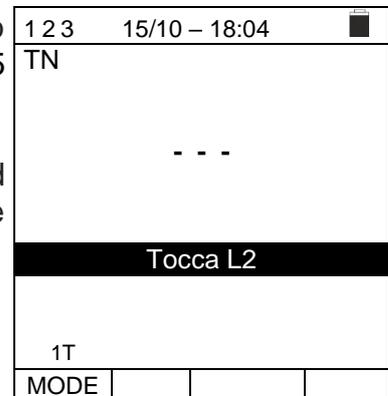
7. Lo strumento emette un suono lungo fino a quando non è presente la tensione di ingresso. Al termine del test, se la sequenza delle fasi rilevata è **corretta**, lo strumento visualizza una videata come quella a lato (risultato "123") e il messaggio "OK"
