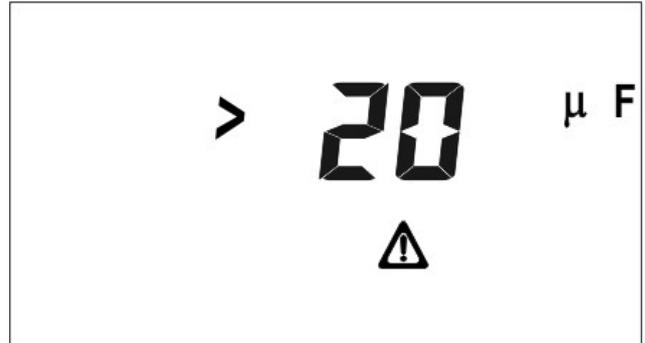
4. Se alla pressione del tasto **START/STOP** (con  $2500V <$  tensione di prova nominale impostata  $\leq 5000V$  e resistenza di carico  $\geq 5M\Omega$ ) la capacità ai terminali di ingresso -Rx, +Rx è  $>$  capacità limite ammessa, viene emesso un segnale acustico prolungato e visualizzata la videata a fianco per 3 secondi. Successivamente lo strumento torna alla videata iniziale.
