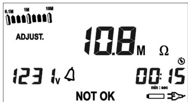
12. Al termine della misura è altresì possibile visualizzare la corrente di perdita, il DAR (Rapporto di Assorbimento Dielettrico), il PI (Indice di Polarizzazione) e la capacità che si presentano ciclicamente alla pressione dei tasti freccia (vedere § 12.1).
