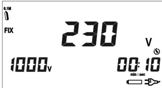
5. Premere il tasto **MODE/CLEAR SMOOTH** per impostare una delle seguenti tensioni di prova: 250V, 500V, 1000V, 2500V, 5000V.
