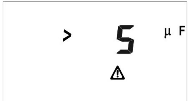
5. Se alla pressione del tasto **START/STOP** o se durante una misurazione viene rilevato un livello di tensione della batteria di alimentazione insufficiente, tale da pregiudicare la buona riuscita della prova, la misurazione non parte o viene interrotta. Viene emesso un segnale acustico prolungato e visualizzata la videata a fianco per 3 secondi. Successivamente lo strumento torna alla videata iniziale.
