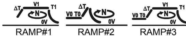
Per ogni tipo di rampa sono programmabili i tempi, le tensioni di prova e il numero di volte che la rampa viene ripetuta (vedere § 5.4.1, § 5.4.2, § 5.4.3)
