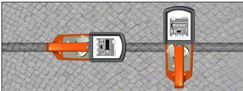
Fig. 12: Allineamento del ricevitore RX5000
