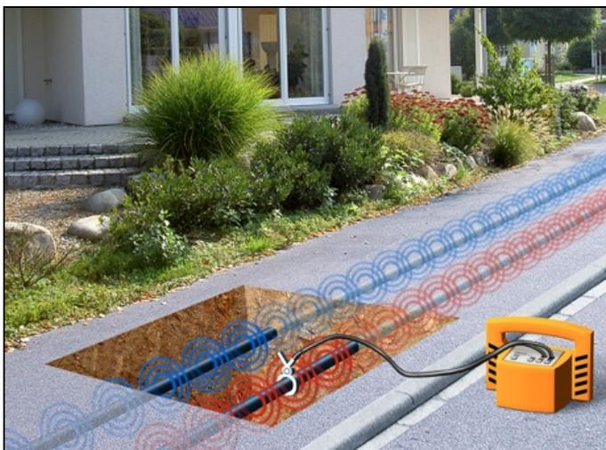
Fig. 6: Accoppiamento tramite pinza a induzione
