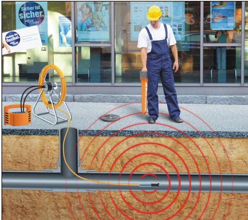
Fig. 9: Localizzazione di servizi non metallici
