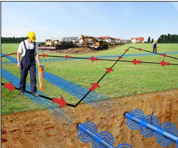
**Sondaggio di un'area di scavo con uso di TX5000 e RX5000.** La distanza tra le due unità deve essere di almeno 15m al fine di evitare le reciproche influenze
