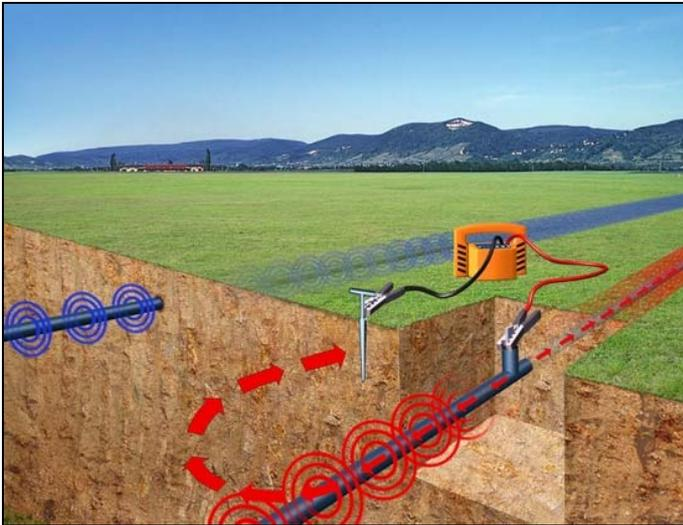
**Accoppiamento diretto a cavi o tubazioni metalliche.** Con questa modalità di lavoro, il segnale viene trasmesso direttamente al sottoservizio tramite cavo, tenaglie di accoppiamento o altri accessori. Applicato a servizi posati in aree aperte e non in tensione
