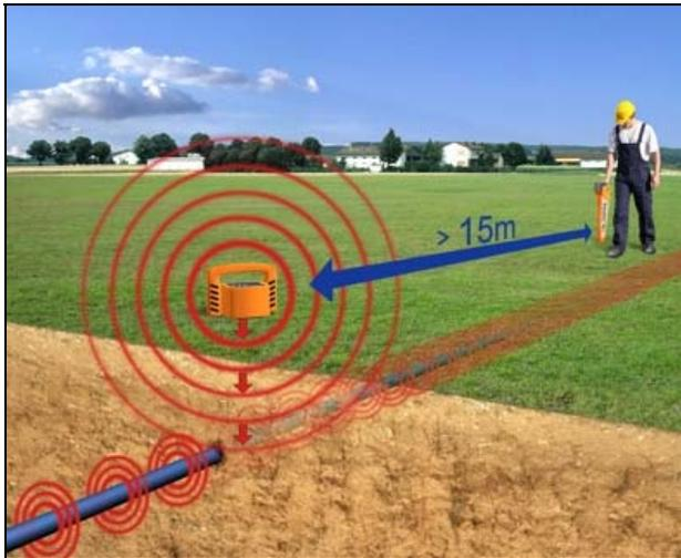
**Accoppiamento induttivo tramite antenna integrata del trasmettitore** da usare quando il servizio non è accessibile (ex: ricerca in un'area di scavo)
